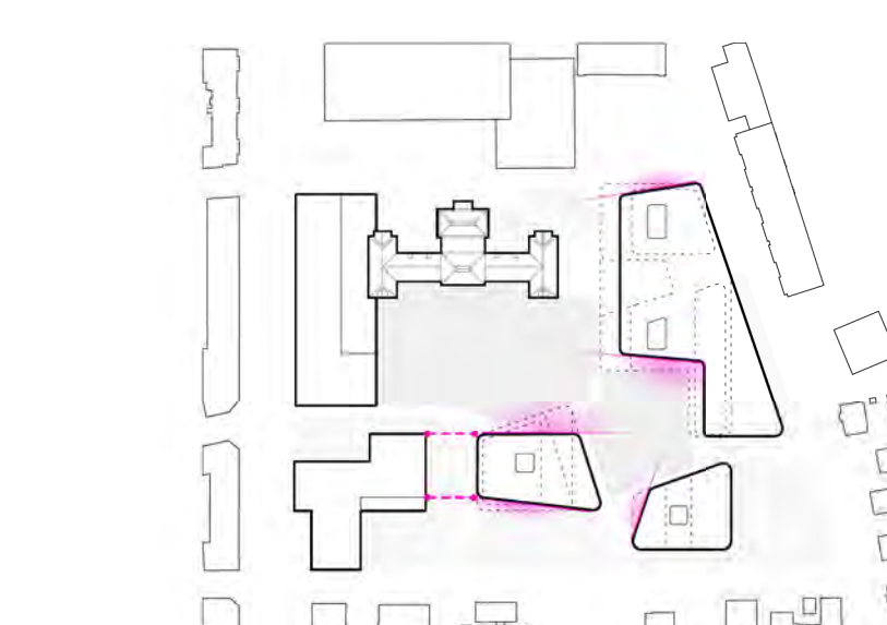
Continuité et ouverture d'itin Les continuités des volumes et leurs liens sont assurés par l'ouverture de l'itinéraire au rez-de-chaussé.
