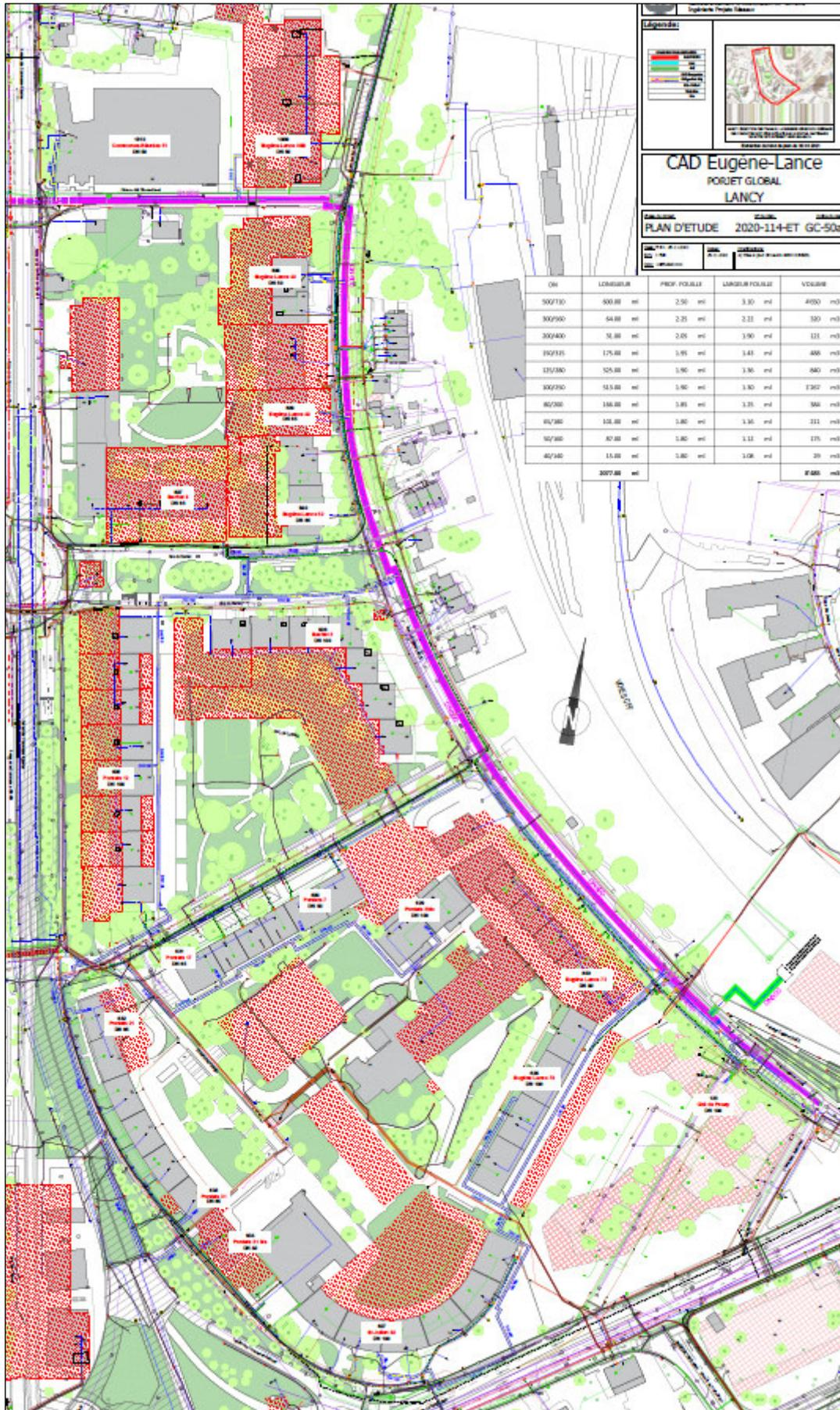
Le tracé proposé pour le réseau structurant a l'avantage d'éviter les arbres et la mise en péril des réseaux existants. Vu les nombreux réseaux existants sous la route, il n'y a pas beaucoup de possibilités pour ce tracé, qui est déjà optimisé.
