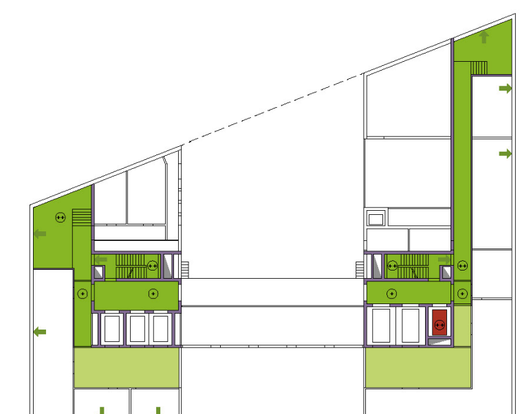
Konzept Brandschutz Erdgeschoss
