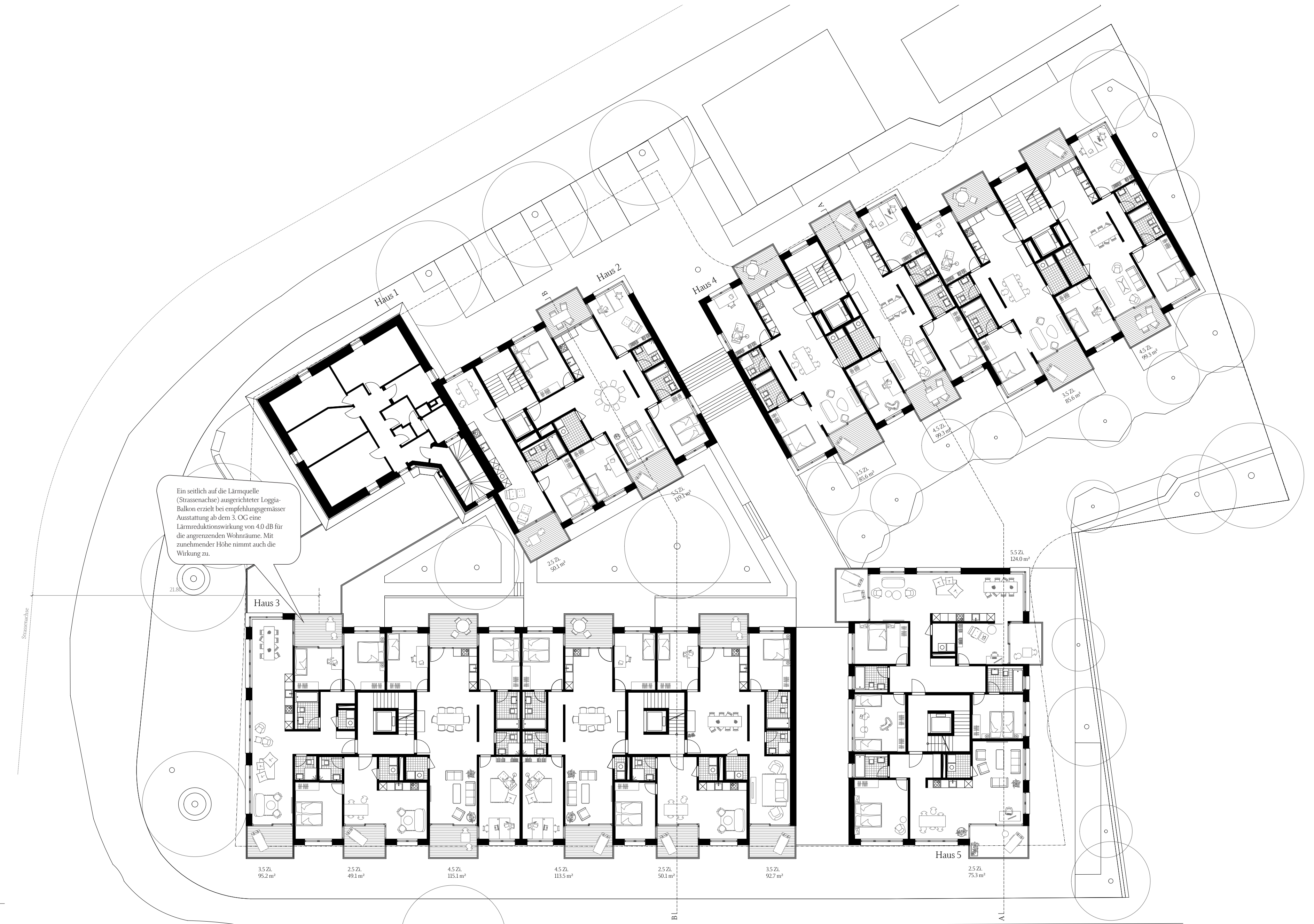
Grundriss 3. bis 5. Obergeschoss 1:500 (Regelgeschoss Wohnen)
