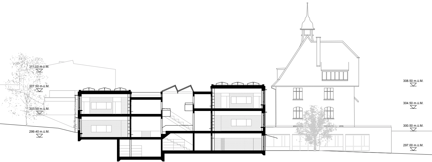
Querschnitt Schulhauserweiterung M 1:200
