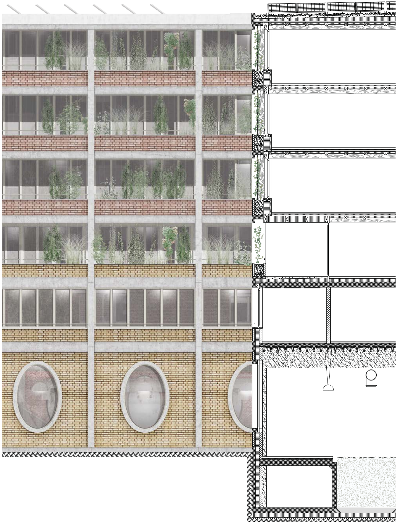
Konstruktionsschnitt und Ausschnitt Fassade 1:125
