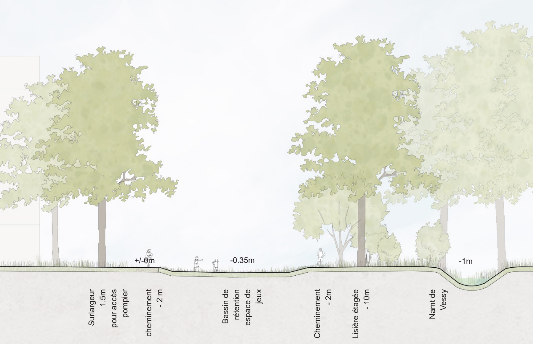
Coupe B-B', 1:200, promenade des Circes, bassin de rétention des eaux de pluie
