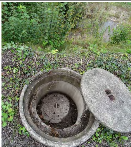
Inklinometermessstelle B3, ca. km 23'03
