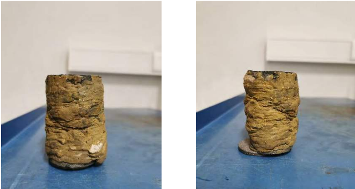
Abbildung 64: Probe GI201483 nach dem Abscheren mit dem sichtbaren Scherband (multi-stage).
