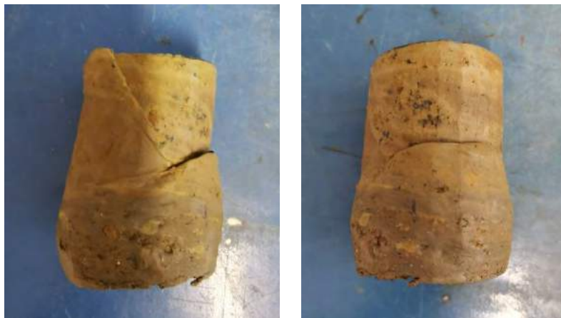
Abbildung 49: Probe GI201541 nach dem Abscheren mit dem sichtbaren Scherband (multi-stage).
