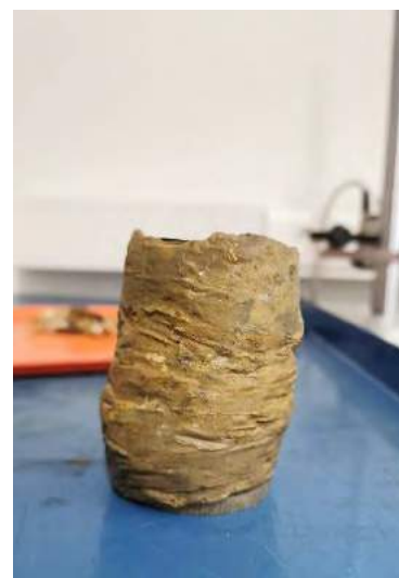
Abbildung 69: Probe GI201466 nach dem Abscheren mit dem sichtbaren Scherband (multi-stage).
