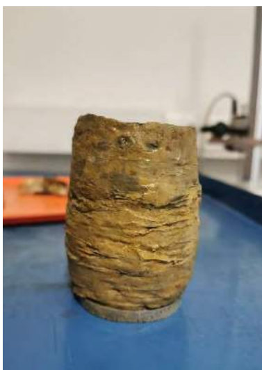
Abbildung 69: Probe GI201466 nach dem Abscheren mit dem sichtbaren Scherband (multi-stage).
