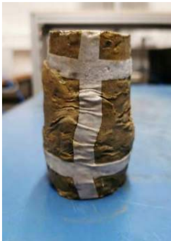
Abbildung 59: Probe GI201471 nach dem Abscheren mit dem sichtbaren Scherband (multi-stage).
