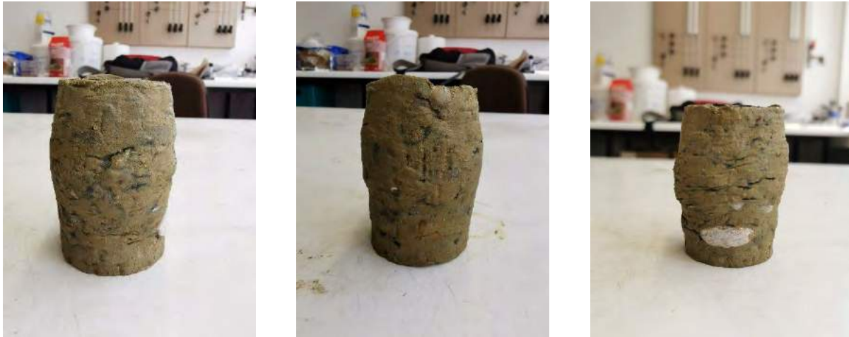
Abbildung 54: Probe GI201479 nach dem Abscheren mit dem sichtbaren Scherband (multi-stage).
