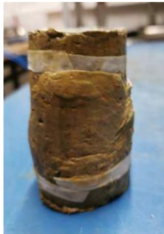
Abbildung 59: Probe GI201471 nach dem Abscheren mit dem sichtbaren Scherband (multi-stage).
