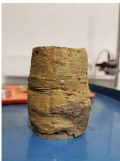
Abbildung 69: Probe GI201466 nach dem Abscheren mit dem sichtbaren Scherband (multi-stage).
