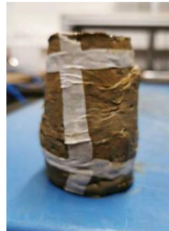
Abbildung 59: Probe GI201471 nach dem Abscheren mit dem sichtbaren Scherband (multi-stage).
