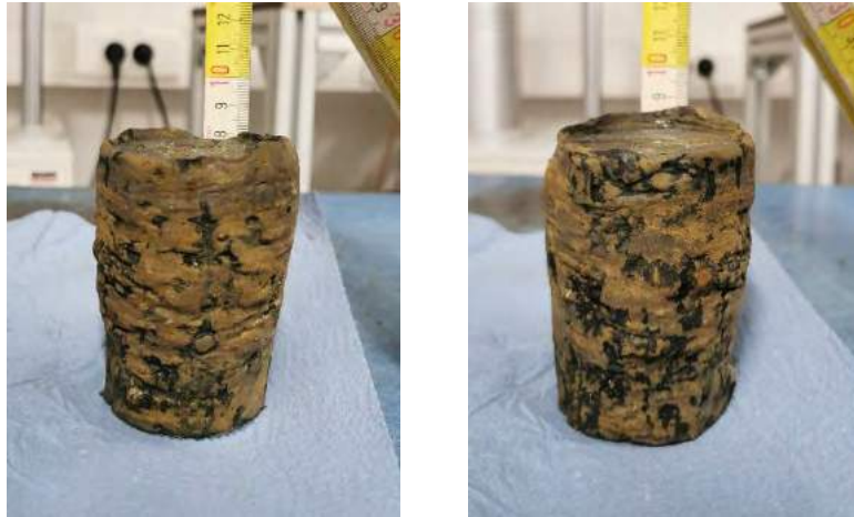
Abbildung 44: : Probe GI201465 nach dem Abscheren mit dem sichtbaren Scherband (multi-stage).
