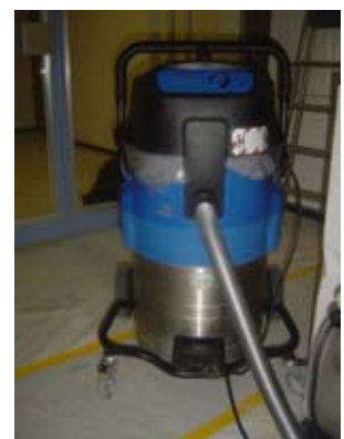
3 Industriestaubsauger mit Filter für Staubklasse H (Asbest)
