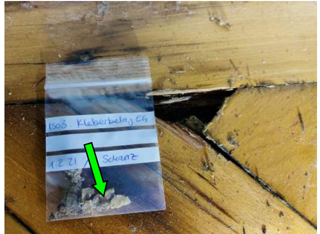
EG, alle Schulzimmer baugleich Detail Iso3: Kleberbelag EG, kein Asbest
