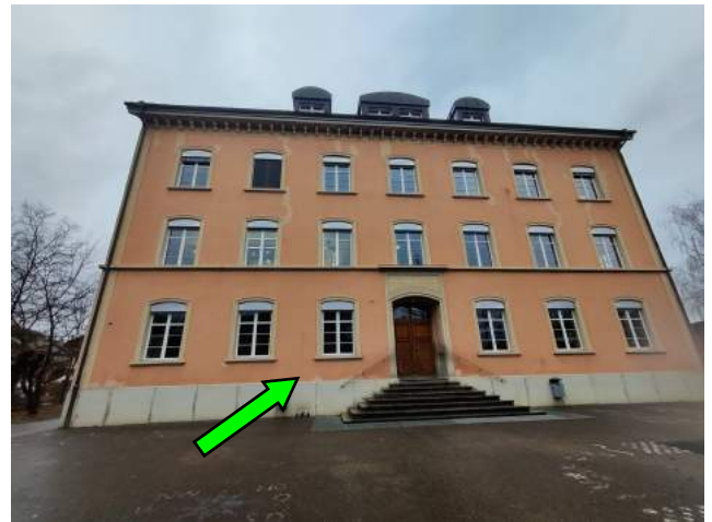
Schulhaus Schanz, Südfassade VP3: Aussenverputz MP, kein Asbest
