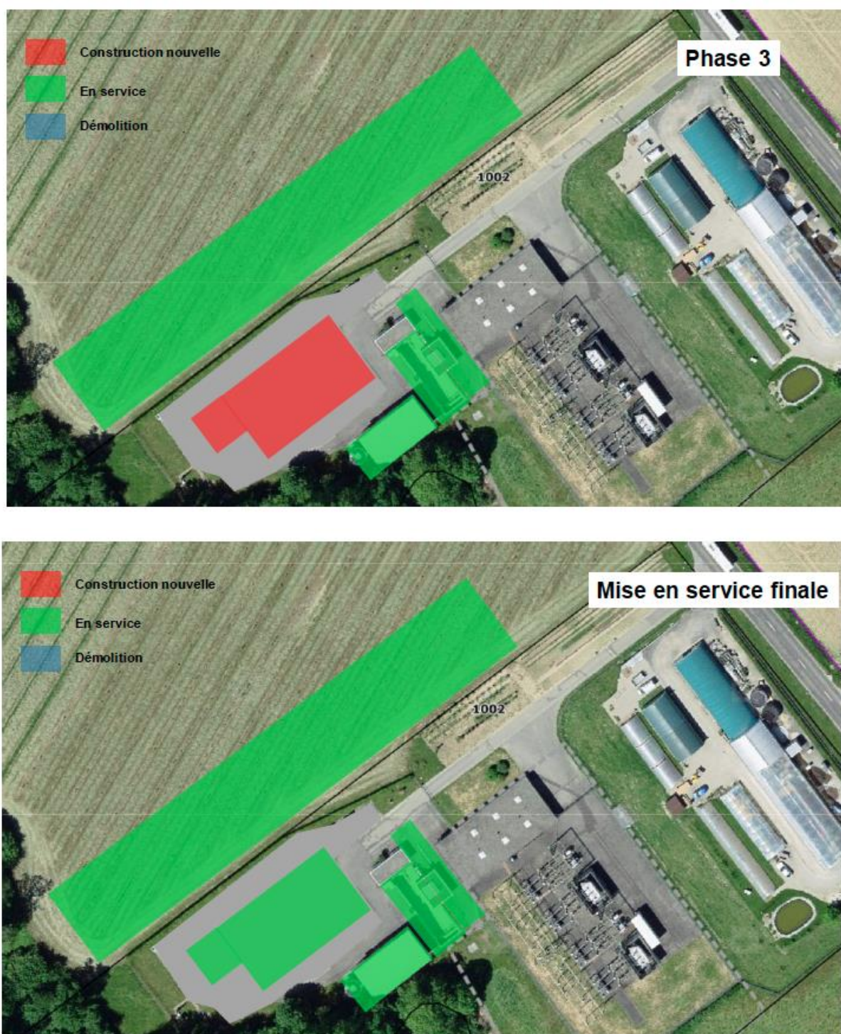
Figure 4.4 : Phasage de construction de la future STEP
