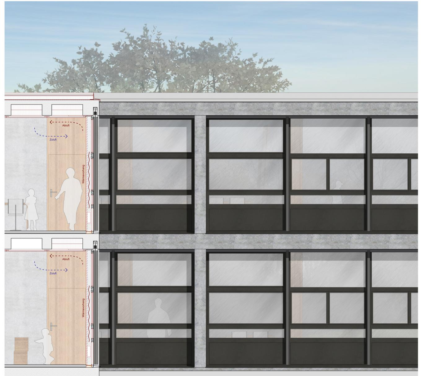
Vertikalschnitt / Ansicht Fassade 1:20
