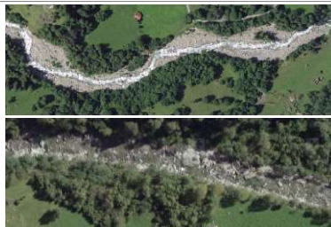
Abbildung E-2 > Gerinneformen. Die Gerinneformen 1 - 5 weisen in der Regel Gefälle \leq 3\% auf, die Gerinneform 6 stellt sich vorwiegend in steilen Gewässern mit einem Gefälle > 3\% ein.
