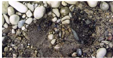
2: Geringe Kolmation. Unter den Deckschichtkörnern hat es wenig siltige und tonige Ablagerungen.
