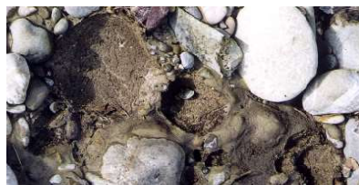
5: Vollständige Kolmation. Der Porenraum ist praktisch flächendeckend mit siltigen und tonigen Ablagerungen verfüllt.
