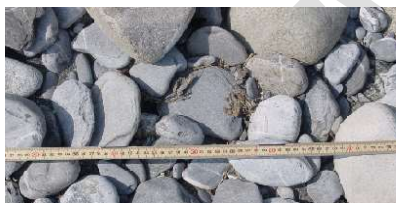
4: Sohlenmaterial mit Gestriebe Zwischen den grossen Körnern des Sohlenmaterials sind Körner des Gestriebes abgelagert.
