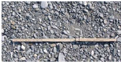
2: Feingestriebe Feinere Anteile des regelmässig transportierten Gestriebes.
