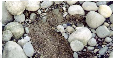
3: Mittlere Kolmation. Der Porenraum ist etwa zu einem Viertel mit siltigen und tonigen Ablagerungen verfüllt.
