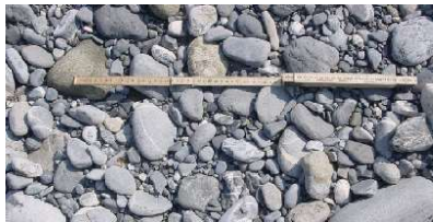
3: Grobgestriebe Gröbere Anteile des regelmässig transportierten Gestriebes.
