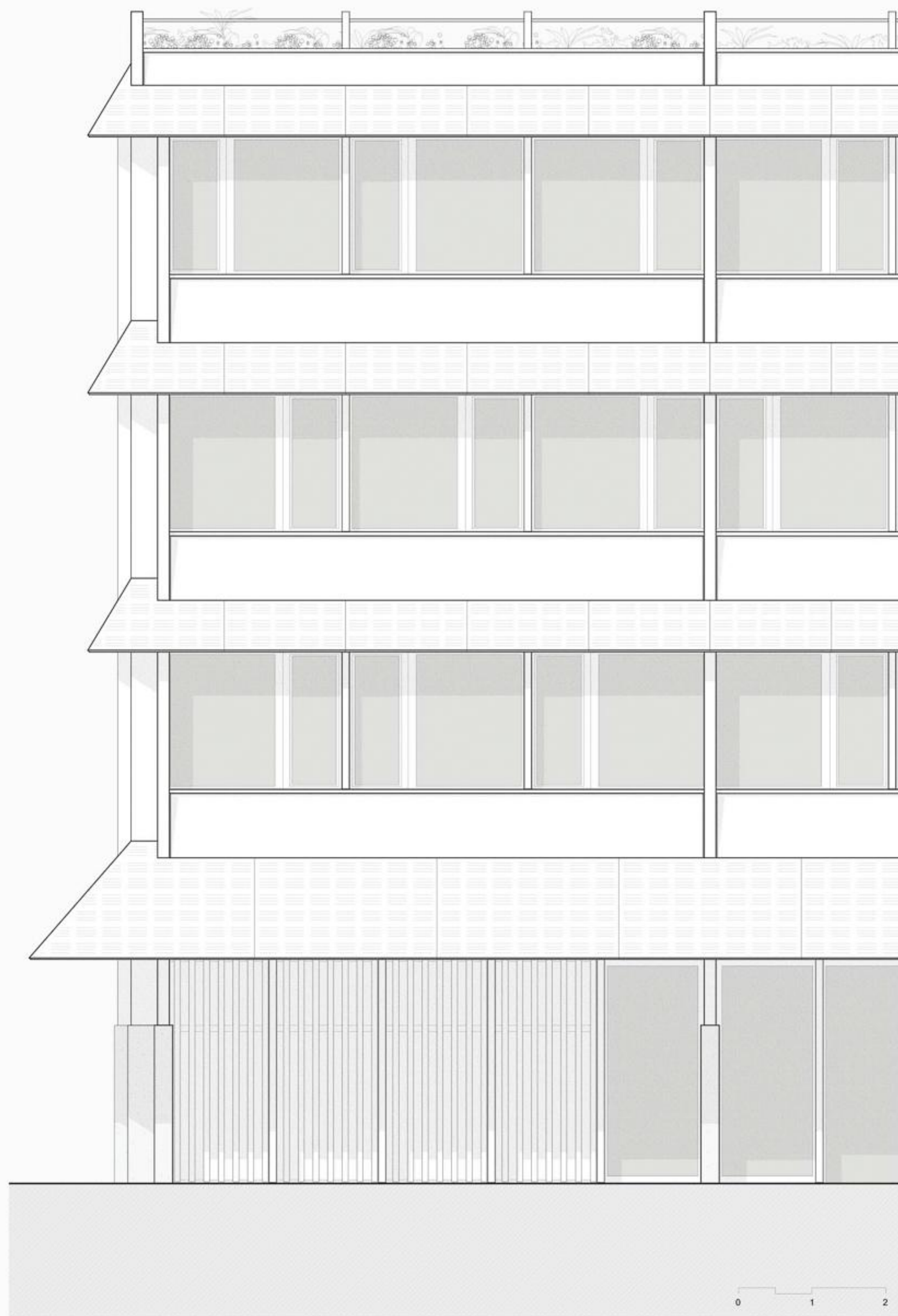
Fassadenschnitt Süd Mst. 1:50
