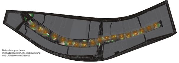
Beleuchtungsschema mit Kugelleuchten, Inselbeleuchtung und Lichterketten (Gastro)
