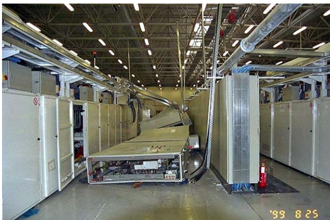
Abb. 1.9 > Funktionsunterbruch oder Funktionsausfall
