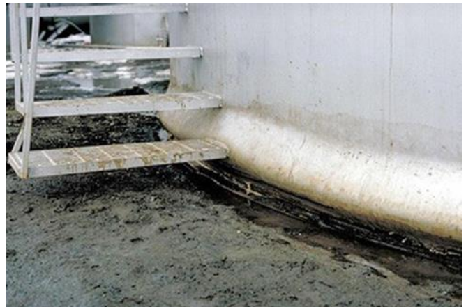
Abb. 2.17.4 > Ausgebeulte Tankwand (sog. «Elefantenfuss»)
