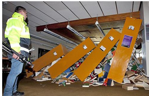
Abb. 2.22.5 und 2.22.6 > Kippen mehrerer Regalreihen infolge des Domino-Effekts
