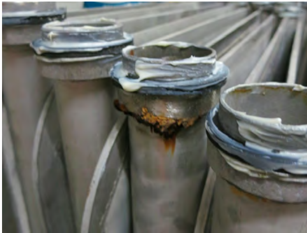
Filterelemente mit Korrosion
