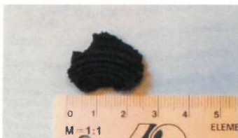
Ausspülung Gummiteil – mutmasslich ein Bestandteil einer Dichtung der Membranventile (KSB)
