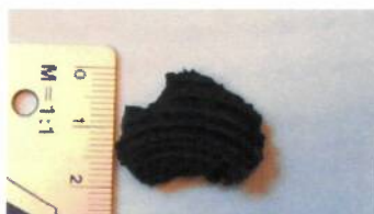
Ausspülung Gummiteil – mutmasslich ein Bestandteil einer Dichtung der Membranventile (KSB)
