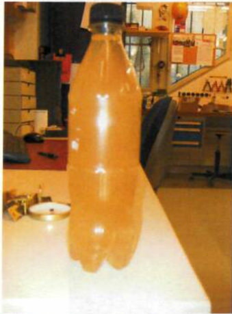
Wassertrübung durch Rost
