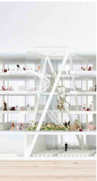
Die Atriumstruktur über dem Plenarsaal ermöglicht dessen stützenfreie Ausbildung.
