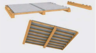
Holzbetonverbunddecke als Prefab-Elemente
