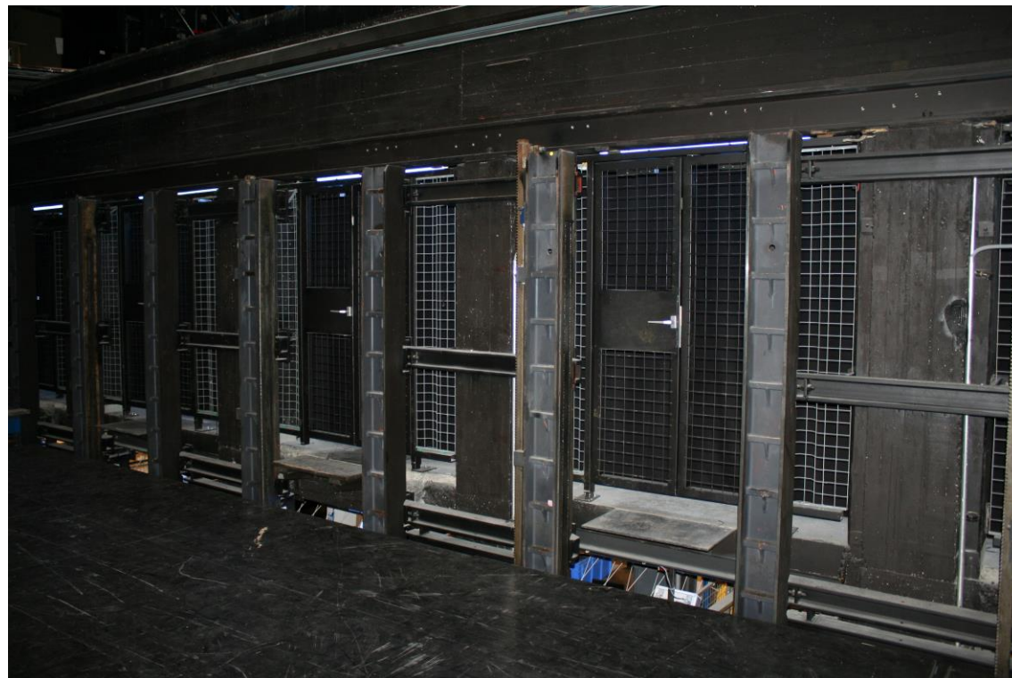
Cotes de verrouillage des ponts : tous les 25cm/ Riegelmaß der Podien alle 25cm
