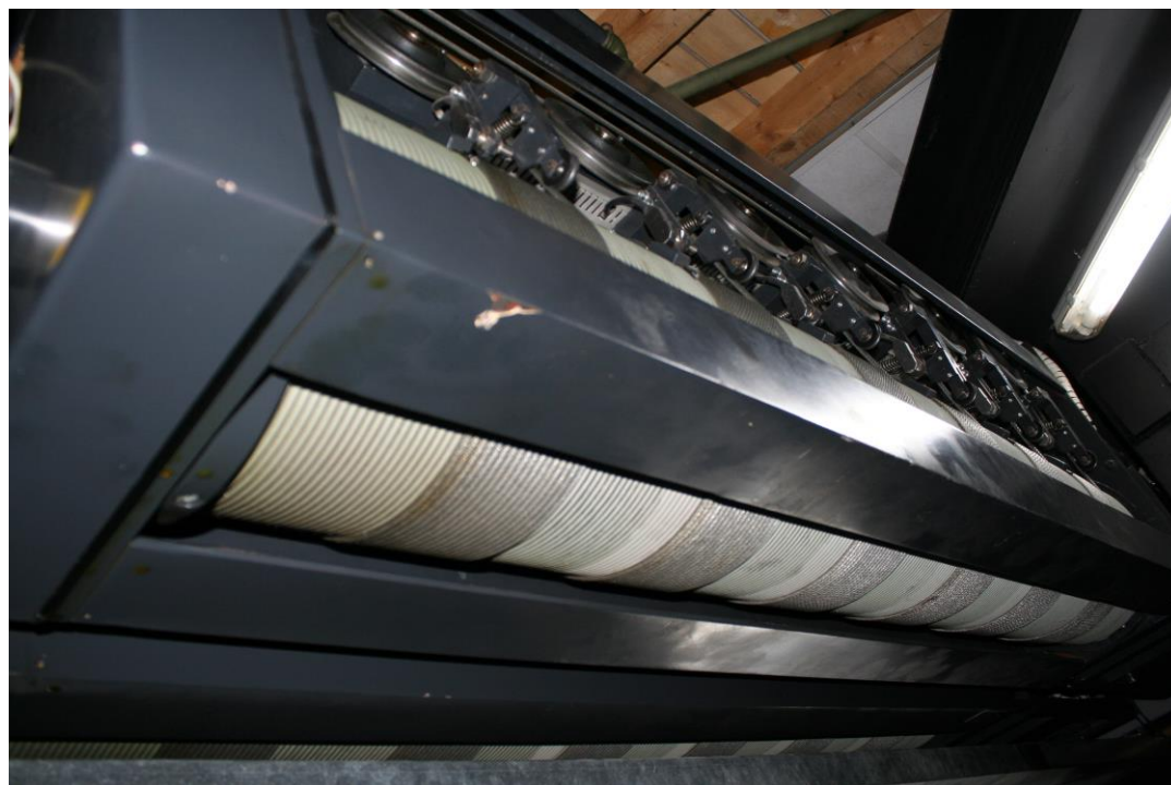
Treuil d'une porteuse de scène au cintre Prospektzugwinde über Schnürbodenebene
