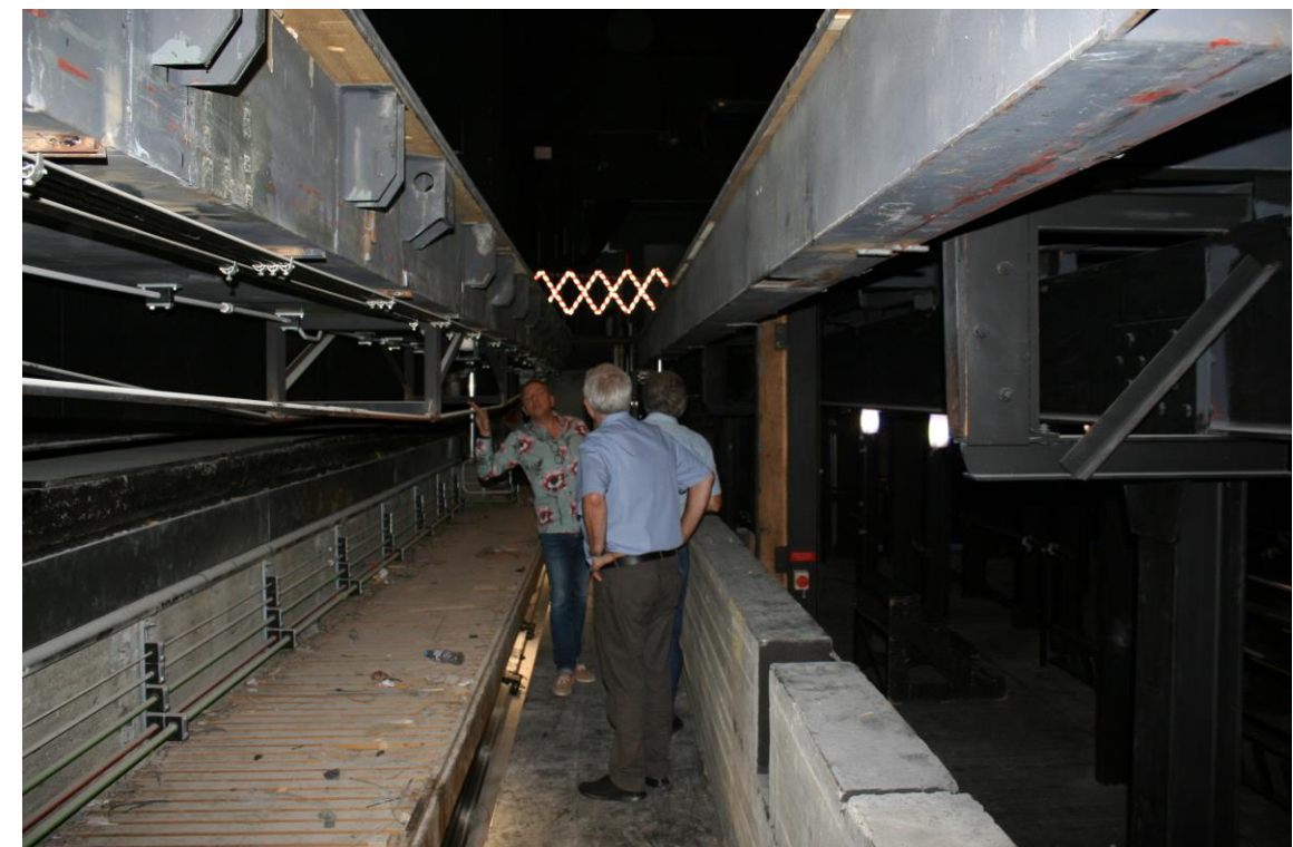
Lift à toile baissé / Prospektlift abgesenkt
