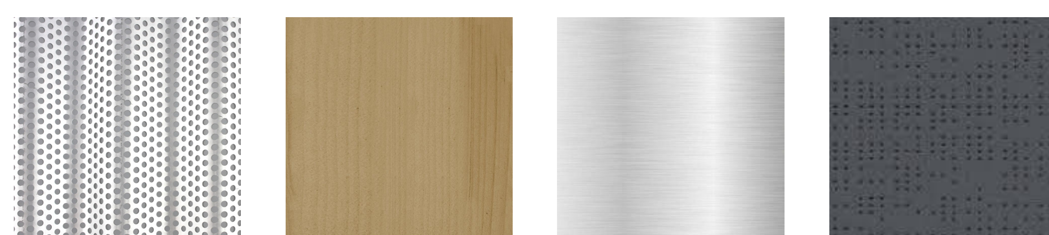
Fassadenverkleidung Trapezblech Aluminium farblos, gelocht Träger, Lisenen, Gurte Fichte natur Fenster Aluminium natur Sonnenschutz Gitterstoff soltis anthrazit
