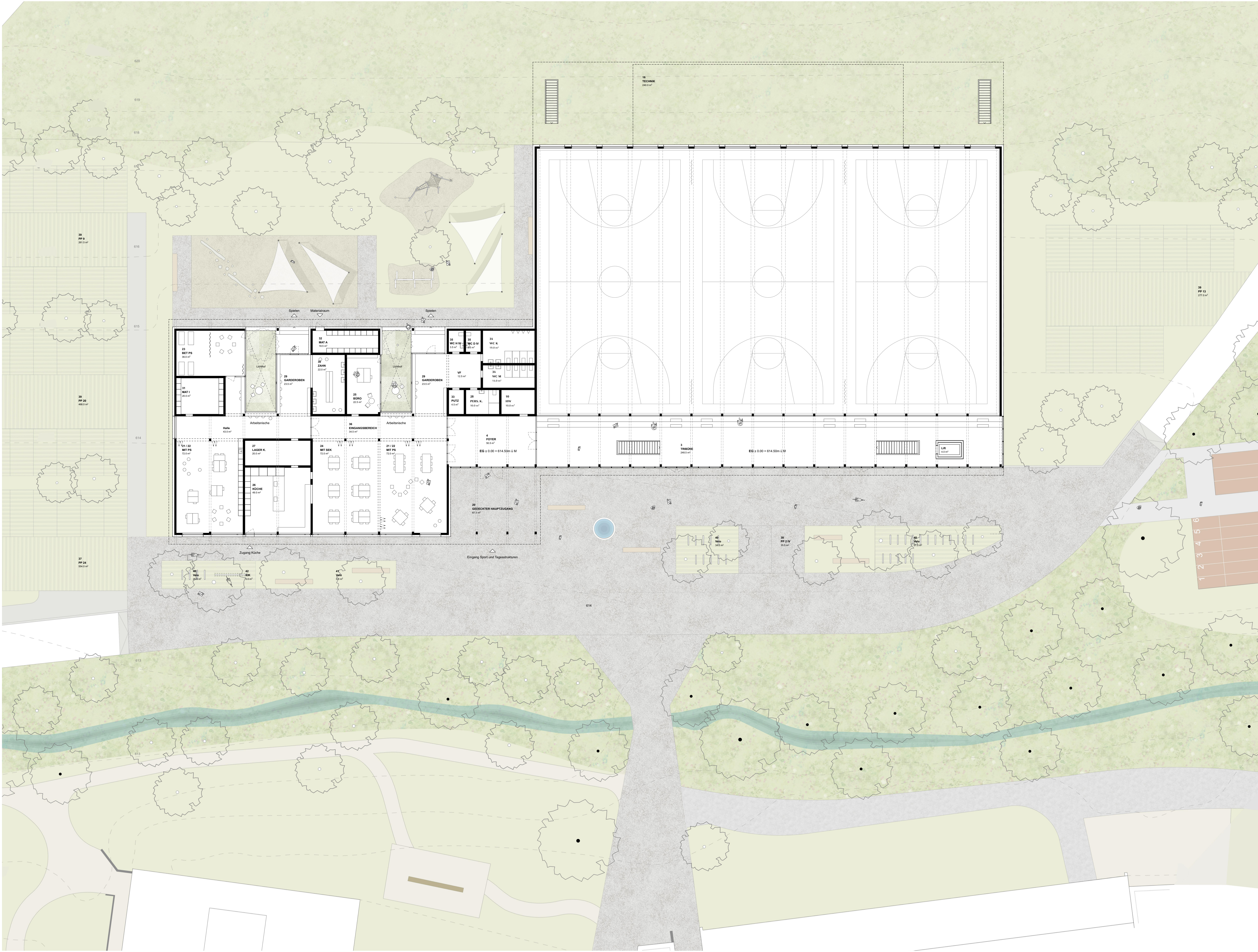
GRUNDRISS EG SPORTHALLE MIT TAGESSTRUKTUREN M.1.200
