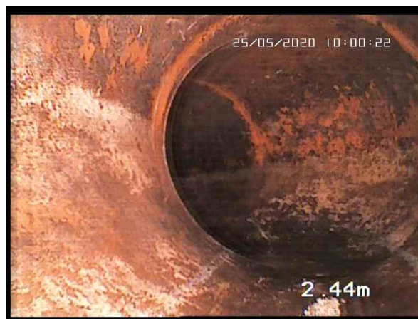
, 00:00:47, 2.44 Courbure vers la gauche, déviation en degrés: 45°
