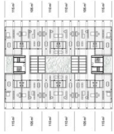
6. OBERGESCHOSS, M 1:200 BÜROEINHEITEN, 72 ARBEITSPLÄTZE, GARDEROBENEHMEN 14 SETZUNGSRÄUMER
