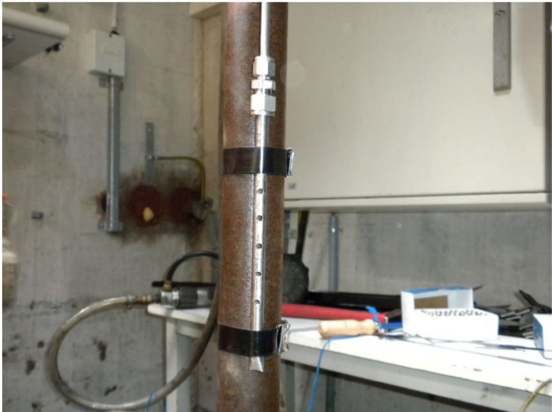
Figur 4: «Port» für eine Beobachtungsleitung in einer Beobachtungszone
