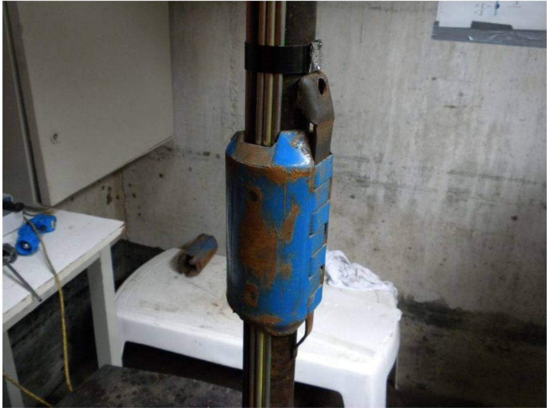
Figur 5: Protektor mit durchgeführten Edelstahlleitungen
