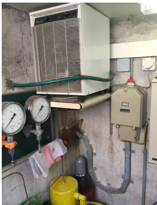
Figur 11: Sicherungskasten der Hauptstromzufuhr (links), Elektrokasten (Mitte), Well-Head mit gebogenen Packer-Inflation-Lines und Stand-Pipes inkl. abgehängten Sensoren (rechts im Vordergrund).
