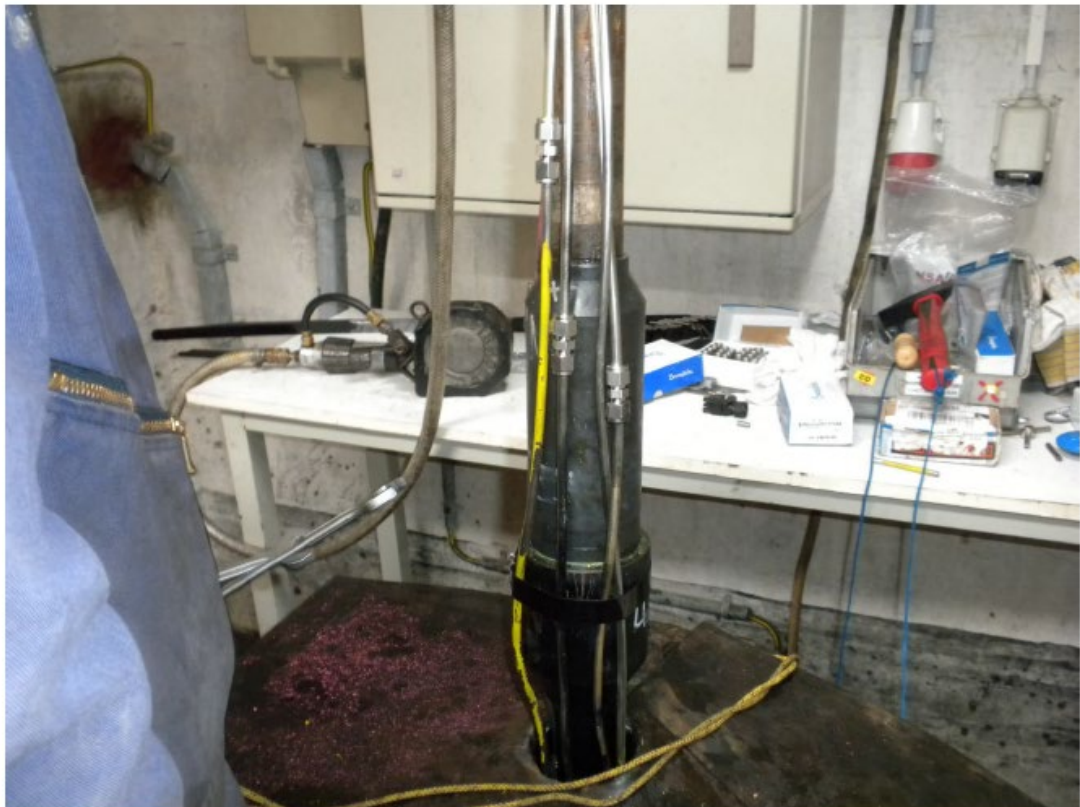
Figur 6: Bereich oberhalb eines Packers mit Edelstahlleitung und Verbindern.
