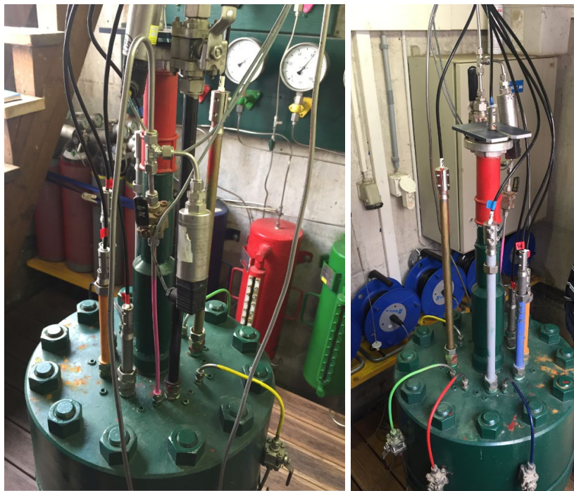
Figur 9.: Well-Head. Die umgebogenen Leitungen sind die Packer-Inflation-Lines, welche auch einen Absperrhahn haben. Die herausstehenden Leitungen sind die Stand-Pipes für die Beobachtungs-zonen. Drucksensoren für artesische Zonen sind am Ende der Leitungen angebracht. Drucksensoren in subartesischen Zonen sind in den Leitungen abgehängt.
