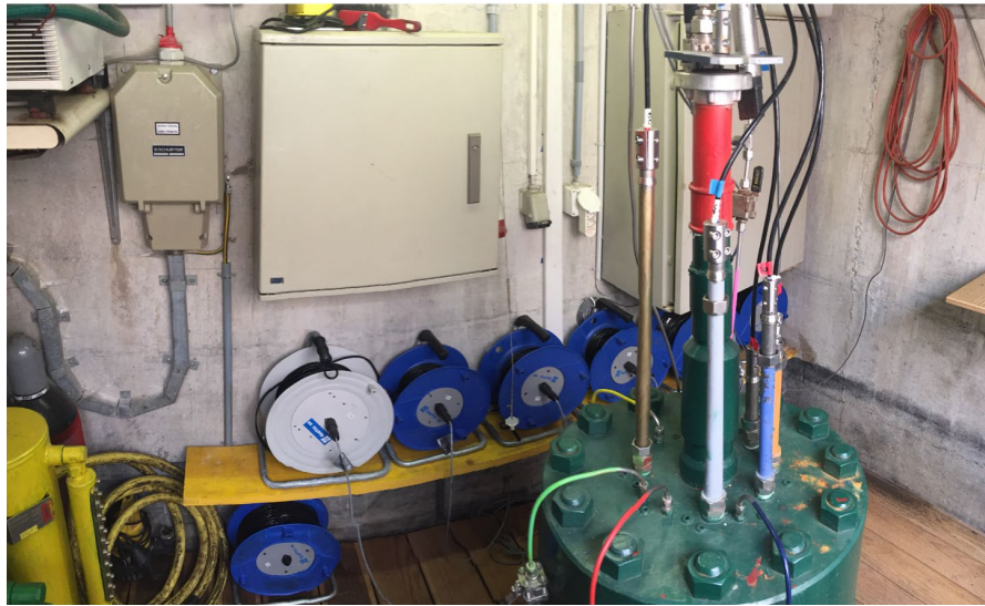
Figur 11: Sicherungskasten der Hauptstromzufuhr (links), Elektrokasten (Mitte), Well-Head mit gebogenen Packer-Inflation-Lines und Stand-Pipes inkl. abgehängten Sensoren (rechts im Vordergrund).
