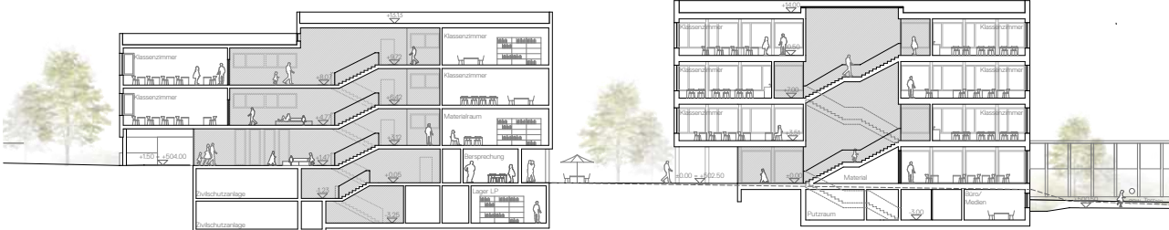
Längsschnitt 1 : 200 Schulhaus Bestand & Schulhaus Neubau
