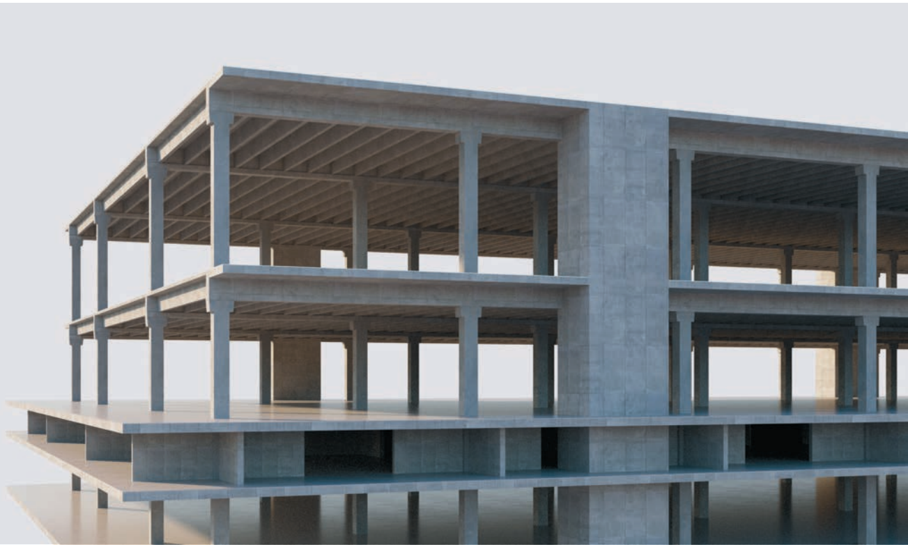
Konzeptmodell Betontragwerk (1. UG, ZG, EG und 1.OG)
