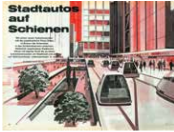
Die StaRRcar-Vision, gezeichnet 1966 nach einer Idee des amerikanischen Ingenieurs William Alden. Dabei handelt es sich um elektrisch angetriebene Fahrzeuge, die entweder mit eigenem Antrieb auf der Strasse oder vollautomatisch auf magnetischen Leitschienen verkehren können. Leider war diese Idee nicht kompatibel mit dem damaligen Höhepunkt der Automobilrenaissance. Coverbild von Klaus Bürgle
