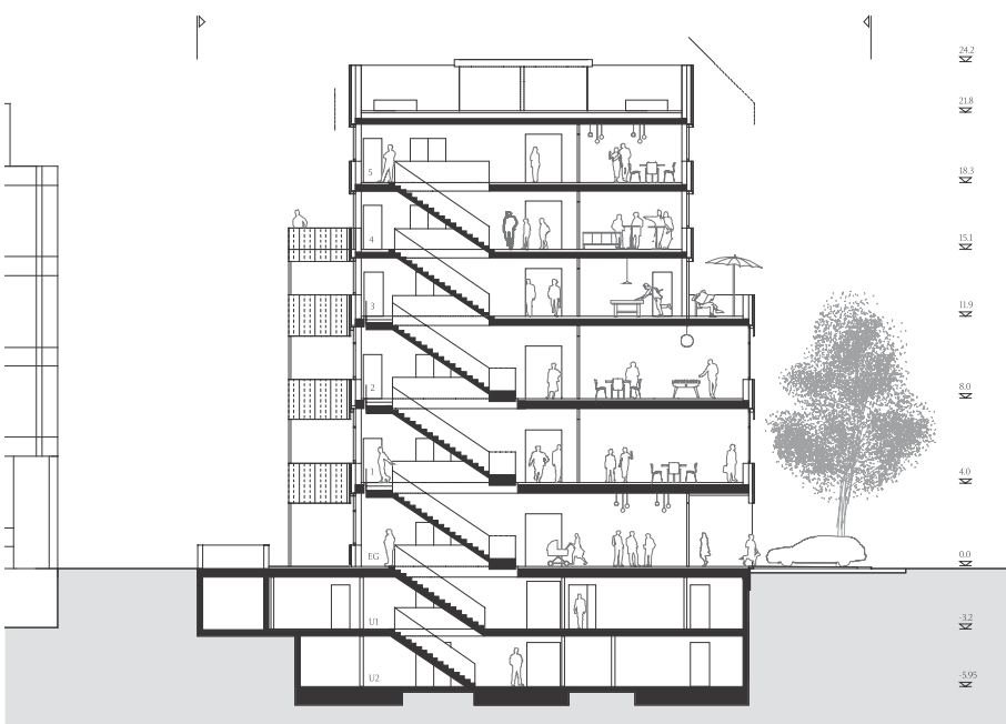
Querschnitt A Treppenhaus 1:200
