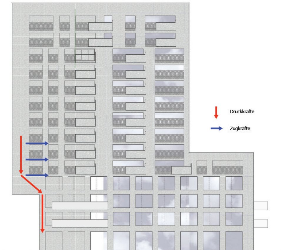
Tragwerksprinzip Hochhaus Bereich Auskragung
