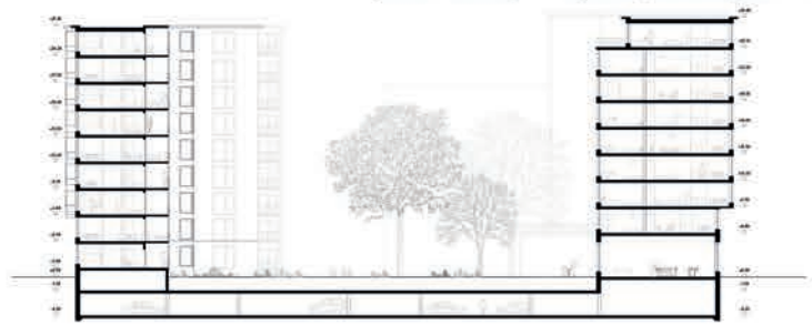
schnitt a-a baufeld 2 1:200
