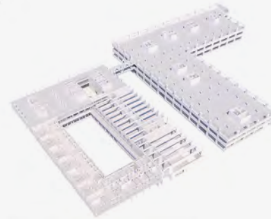
La passerelle créée au 1 er et au 2 e étage relie les deux immeubles existants et les nouveaux bâtiments des deux bâtiments.
