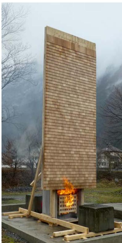
Beim Realbrandversuch wurden die am vorangehenden Kleinbrandversuch gemachten Erfahrungen bestätigt.
