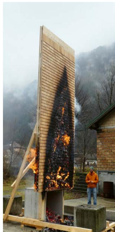
Nachdem die Stützflamme reduziert wurde, stagnierte die Ausbreitung des Feuers auf der Fassade.
