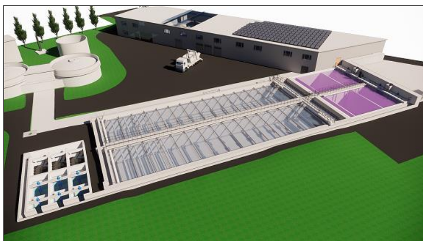
Figure 6.30 Vue 3D du traitement biologique MBBR et de la clarification
