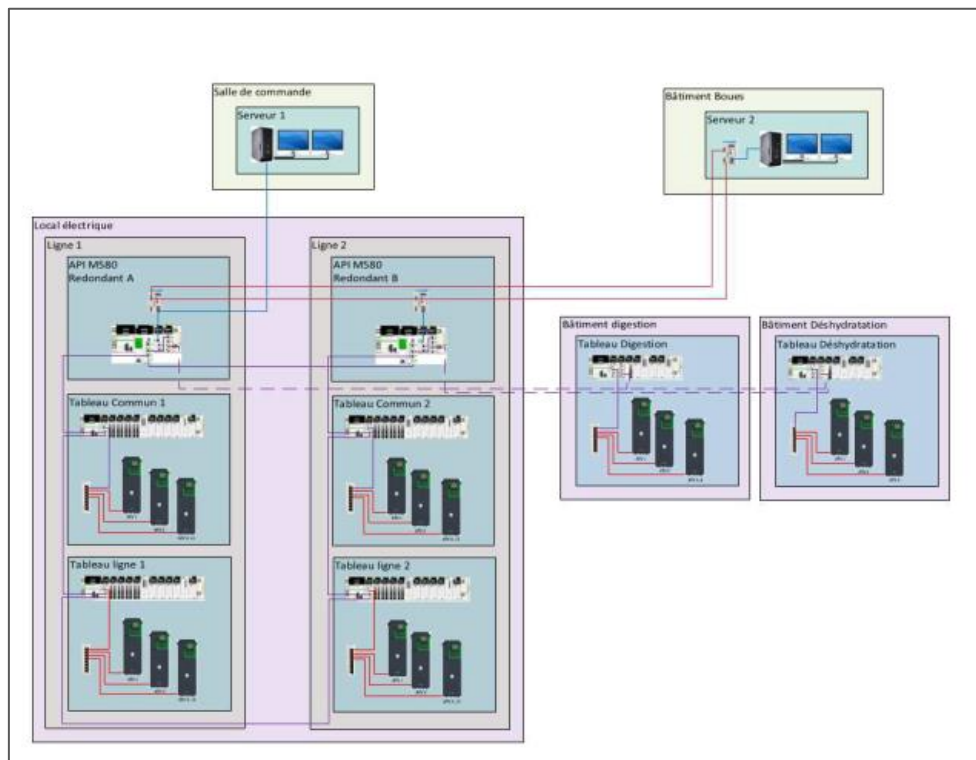
Figure 7.5 Exemple de schéma d'architecture automate
