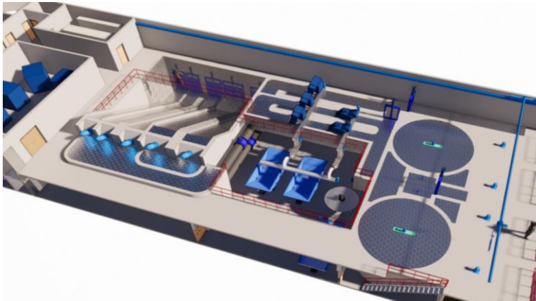
Figure 6.11 Vue 3D de l'implantation de l'étape de dégrillage
