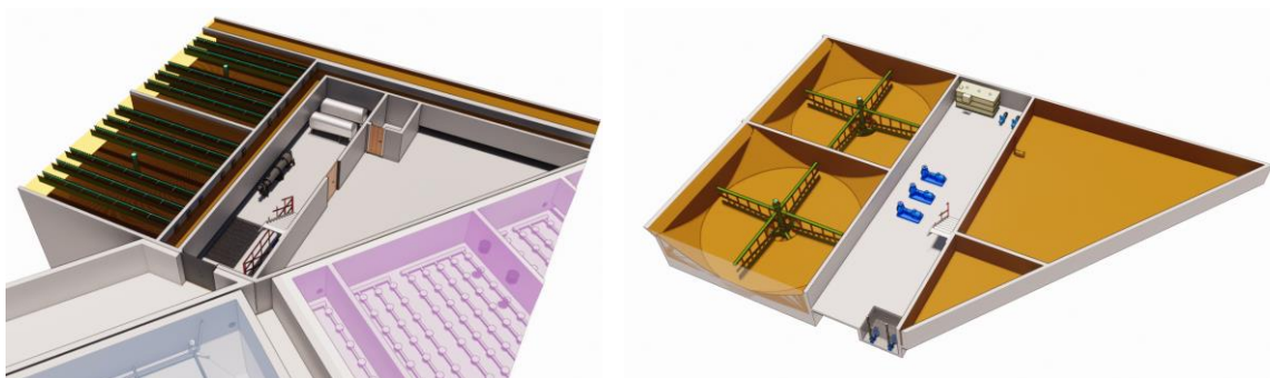
Figure 6.38 Vue 3D des bâches de stockage des boues
