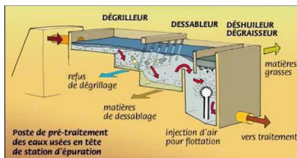
Figure 6.6 Vue schématique des étapes du prétraitement
