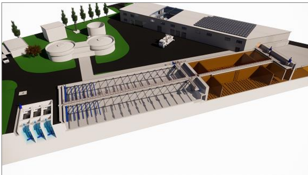
Figure 7.29 Vue 3D en coupe du traitement biologique et de la clarification
