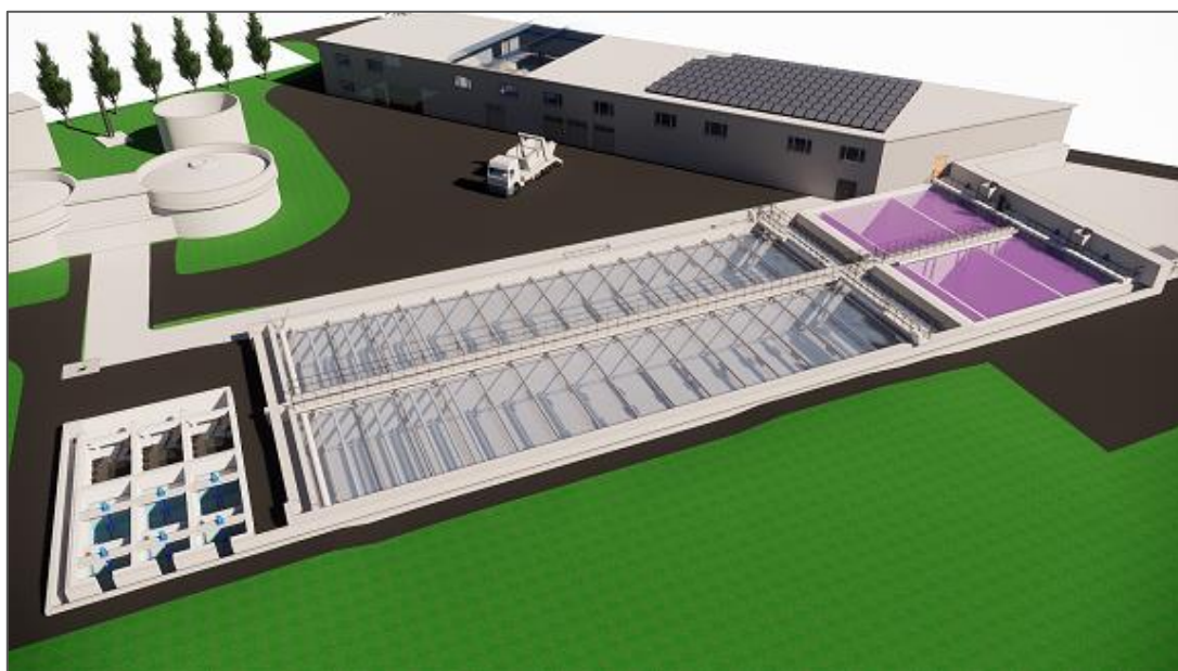
Figure 7.32 Vue 3D du traitement biologique MBBR et de la clarification
