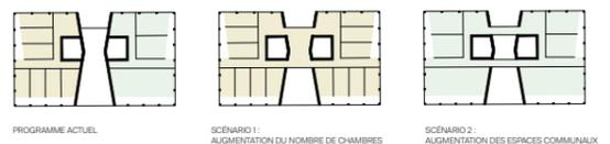
Le foyer est l'espace qui sépare les deux programmes et évite une situation mitoyenne, acoustiquement et fonctionnellement problématique. De plus, cet espace est imaginé comme pouvant être utilisé par les différents programmes du bâtiment. En fonction des usages, cet espace pourra fonctionner indépendamment, en lien avec l'espace de projections situé au sous sol, avec le restaurant, la salle polyvalente ou encore comme extension du hall de la commune.
