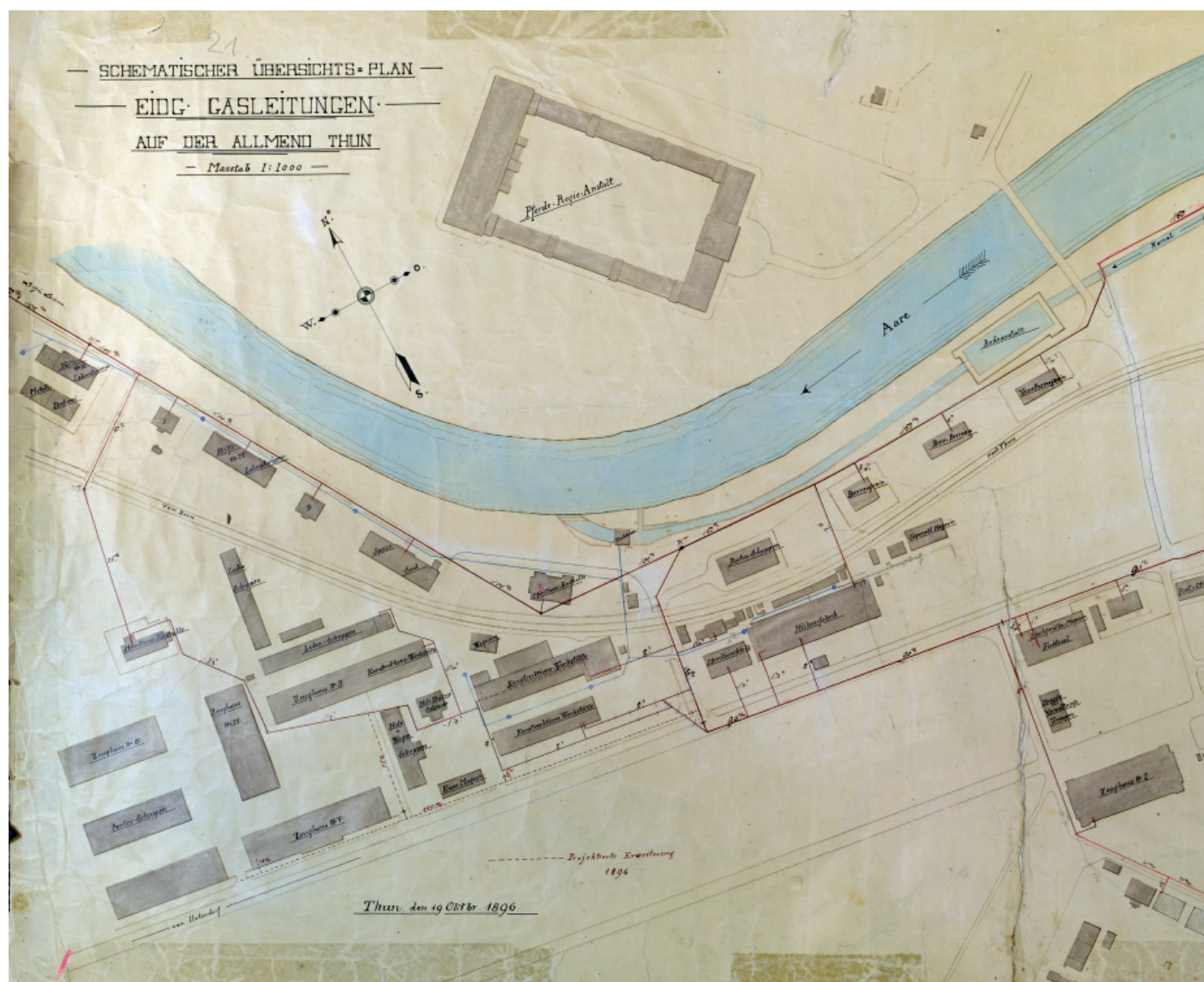
Schematischer Übersichtsplan Eidg. Gasleitungen auf der Allmend in Thun, Ausschnitt
