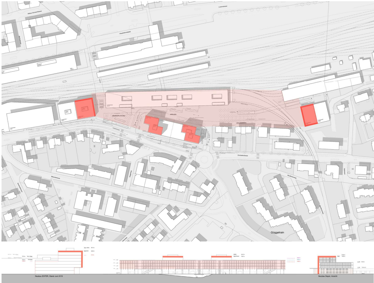
Abbildung 13: Plan und Schnittansicht zeigen die Höhenakzente und die Massstäblichkeit der Bauten im Kontext: Enter 16 und 25,5m / RBS mit Mantelnutzung ca. 16m / Neubau im aufgelassenen Depot RBS 21,5 m
