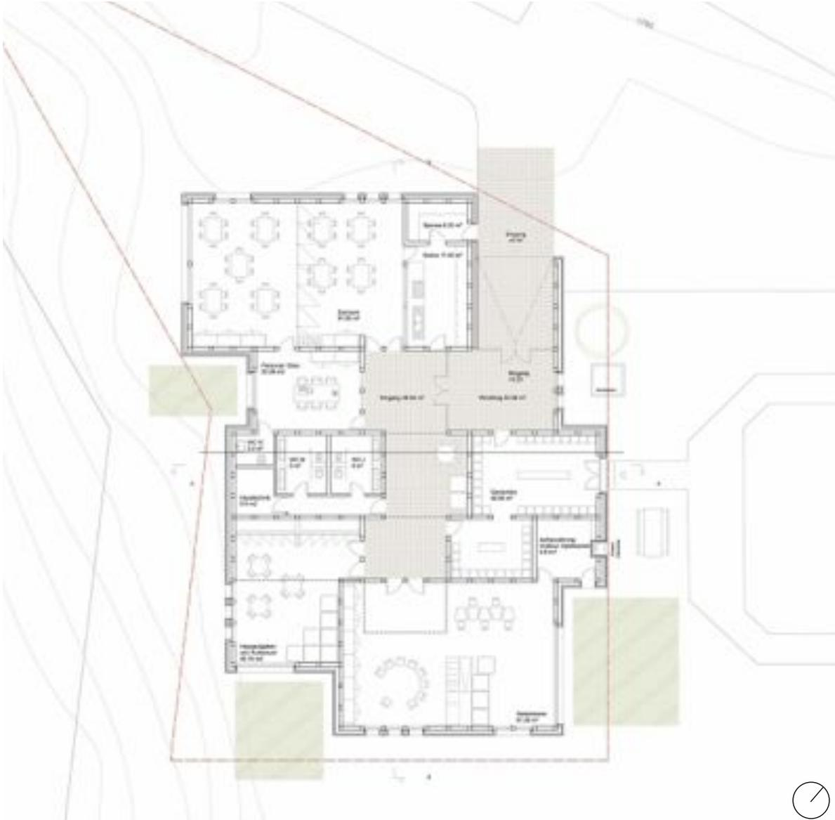
Grundriss Erdgeschoss mit Umgebung
