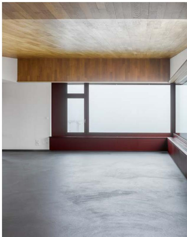
**Hier sollte die Aussicht sein** – leider herrschte beim Fototermin Nebel. Gut erkennbar ist der eingebaute Sturz der Fenster. Trotz der Umstellung von einer Ölheizung auf eine Luft-Wasser-Wärmepumpe konnte das bestehende Fussboden- und Radiatorenheizsystem weiterverwendet werden.
