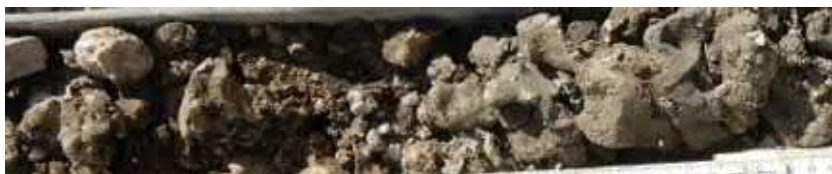
Abbildung 5: Deckschicht aus RKB 19-2/P (Tiefe 1.4-1.8 m)
