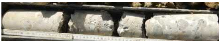
Abbildung 10: Unverwitterter Nagelfluh aus RKB 19-1/P (Tiefe 11.0 – 11.5 m)
