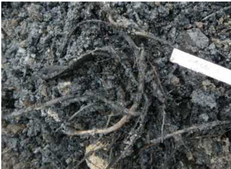
Abbildung 3: Künstliche Auffüllungen aus BS 16-1/P mit vielen Wurzeln, Keramik und Metall, chemisch / öligem Geruch (Tiefe ca. 1.6 - 2.0 m)
