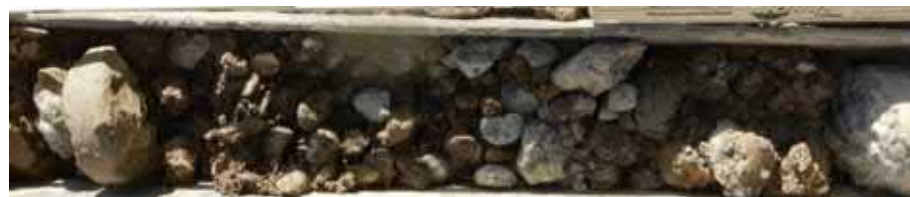
Abbildung 9: Verwitterte Nagelfluh aus RKB 19-3/P (Tiefe 11.6 – 11.9 m)
