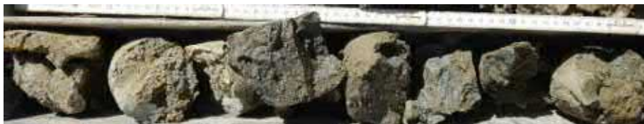
Abbildung 8: Verwitterter Mergel aus RKB 19-2/P (Tiefe 11.0 – 11.6 m)
