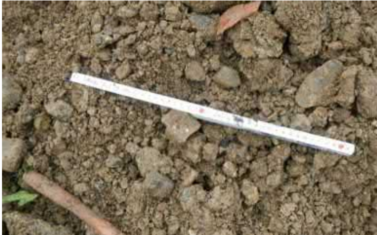
Abbildung 2: Künstliche Auffüllungen mit Fremdstoffen aus BS 16-2/P (Tiefe ca. 0.1 - 0.5m)
