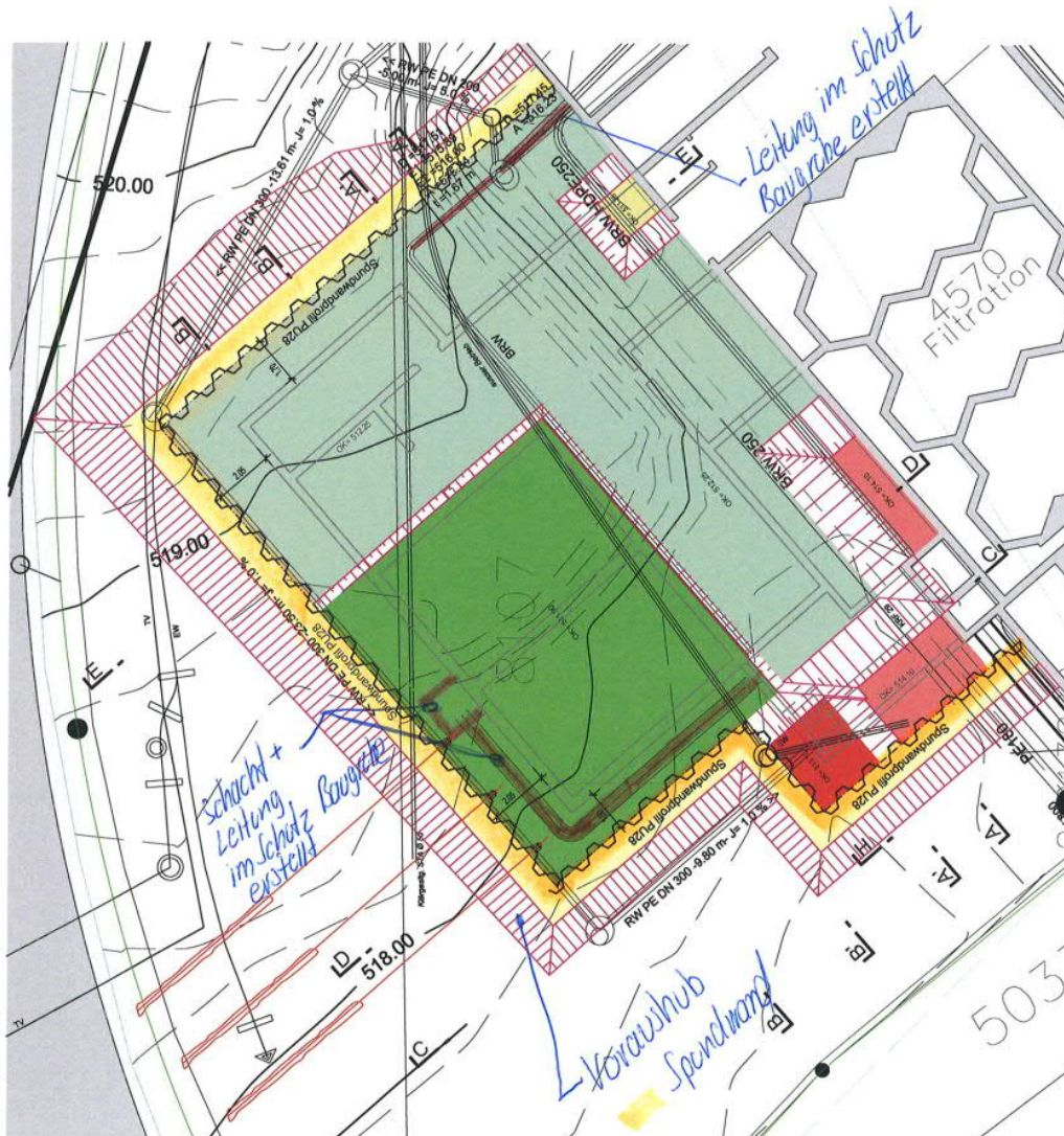
Abbildung 75: Baugrube Etappe 1; Grundriss
