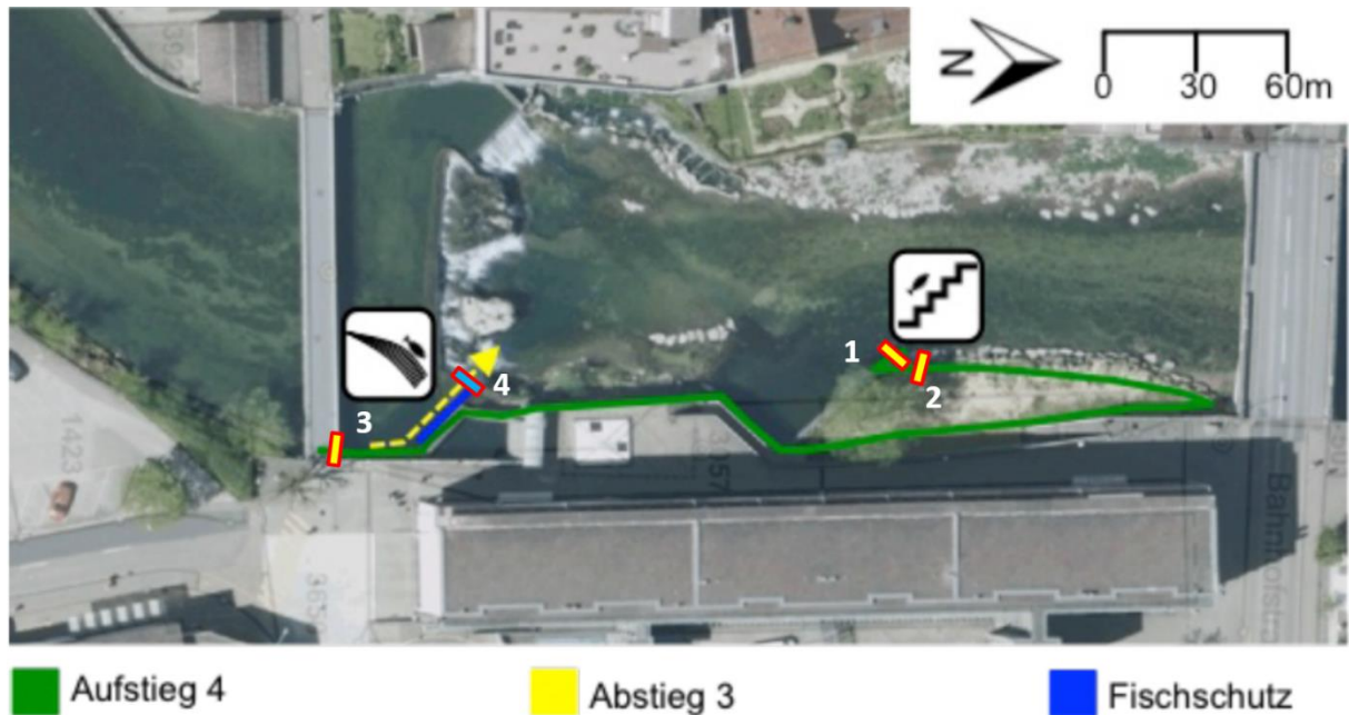
Abbildung 7: KW Wasserfall Laufen. Eingezeichnet sind die Bestvarianten für den Fischauf- und -abstieg nach der Machbarkeitsanalyse der Energiebüro AG (2017a) aus der auch die Abbildung übernommen wurde. Eingezeichnet sind die ungefähren Antennenstandorte für den Aufstieg (rot-gelbe Balken, 1-3) und die Antenne für den Abstieg (rot-blauer Balken, 4). Genauere technische Pläne standen zum Zeitpunkt des Erstellens dieses Konzeptes nicht zur Verfügung.
