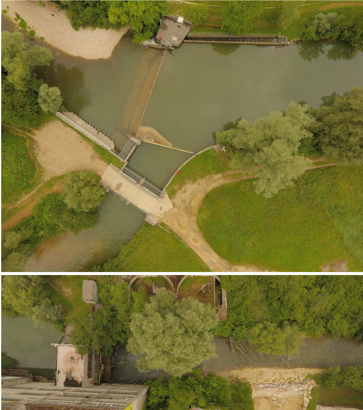
Abbildung 9: Oben: Luftaufnahme des Ausleitungswehres des KW Obermatt Zwingen mit Borstenfischpass am oberen Bildrand. Unten: Luftaufnahme des KW Obermatt Zwingen. Die Watbarkeit ist im Staubereich des Ausleitungswehres und in der Ausleitungsstrecke schwierig. Die unterwasserseitige Ausleitungsstrecke scheint hingegen teilweise watbar. Fotos vom 7.6.2018.
