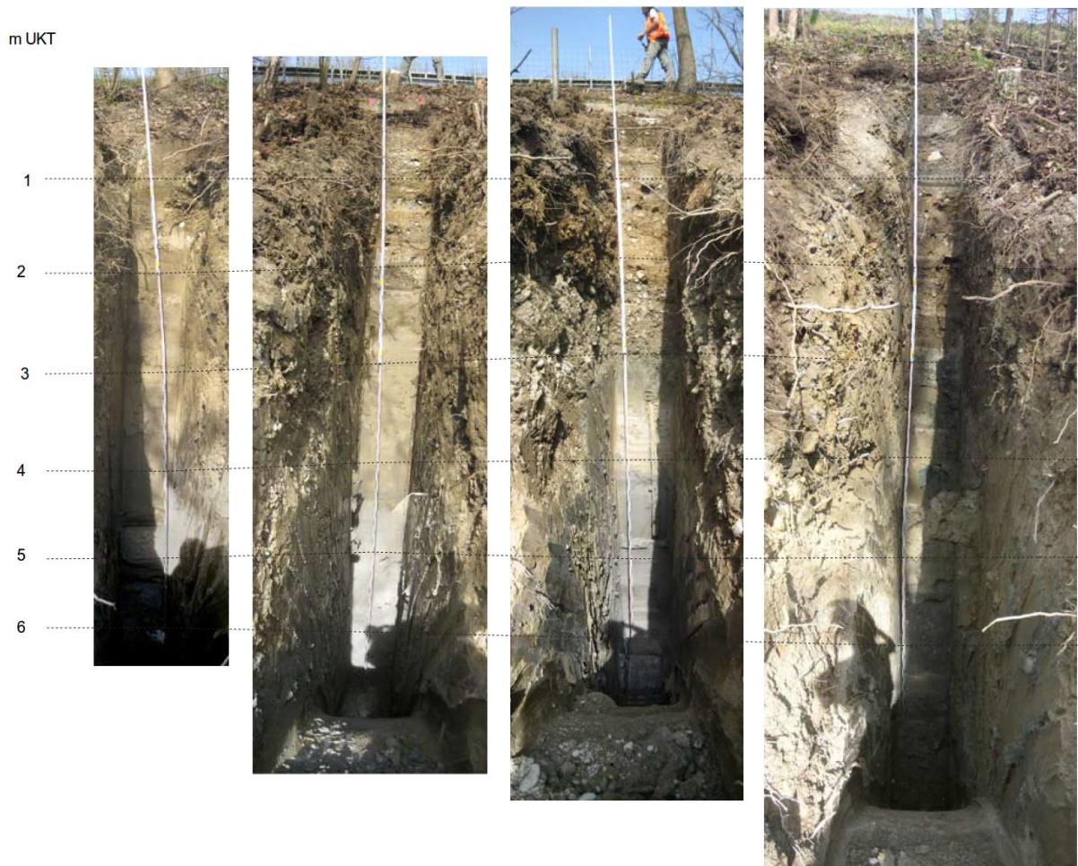
Abbildung 18 Fotos Baggerschlitzte
