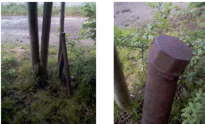
Abbildung 1: Abgeschraubtes Piezometerrohr bei Koordinate ca. 606'259 / 195'263
