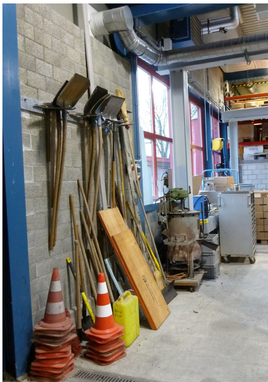
Abb. 12: Werkzeuge und Gerätschaften im Sektor C. An der Decke ist der Ausblasanschluss durch die Außenwand ins Freie für die Staubabsaugung zu erkennen.
