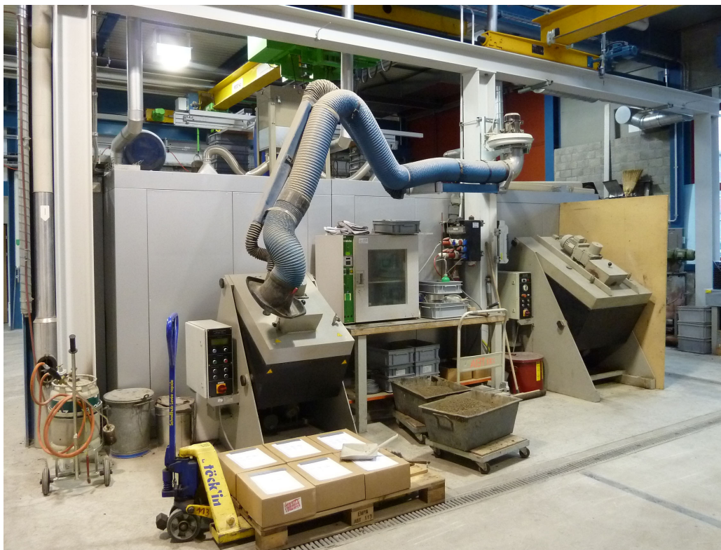
Abb. 8: Sektor B (Blickrichtung auf den Ofenbereich im Sektor C) mit Misch- und Mahlständen. Gut zu erkennen sind die Staubabsauganlage und Teile des Deckenhallenkrans.
