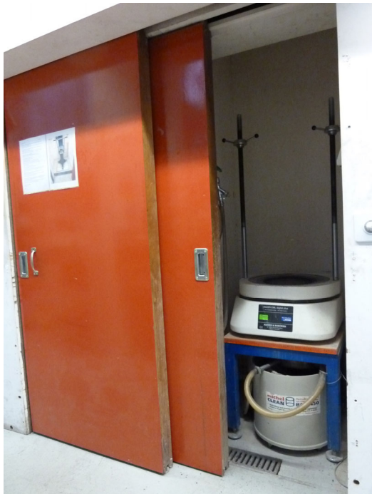
Abb. 25: Prüfeinrichtung im Sektor G (BP 101). Aufgrund der hohen Lärmimmissionen befindet sich die Anlage zusätzlich noch in einem separaten Schallschutzgehäuse.
