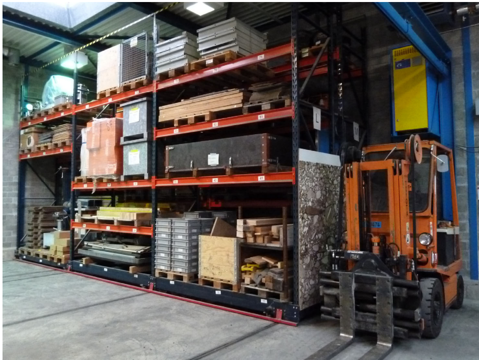
Abb. 4: Wandseitig das letzte Compactus-Rollregal, daneben die Ladestation (LS) und Abstellplatz für den Gabelstapler. Der Mindestabstand zwischen den Rollregalen muss gross genug sein, um mit dem Stapler dazwischen rangieren zu können.
