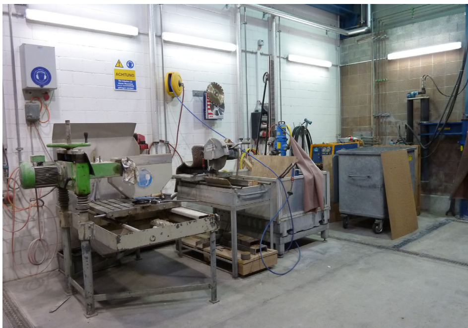
Abb. 14: Sog. Nassbereich zum Trennen/Bohren (mit Schlammabscheider) im Sektor D.
