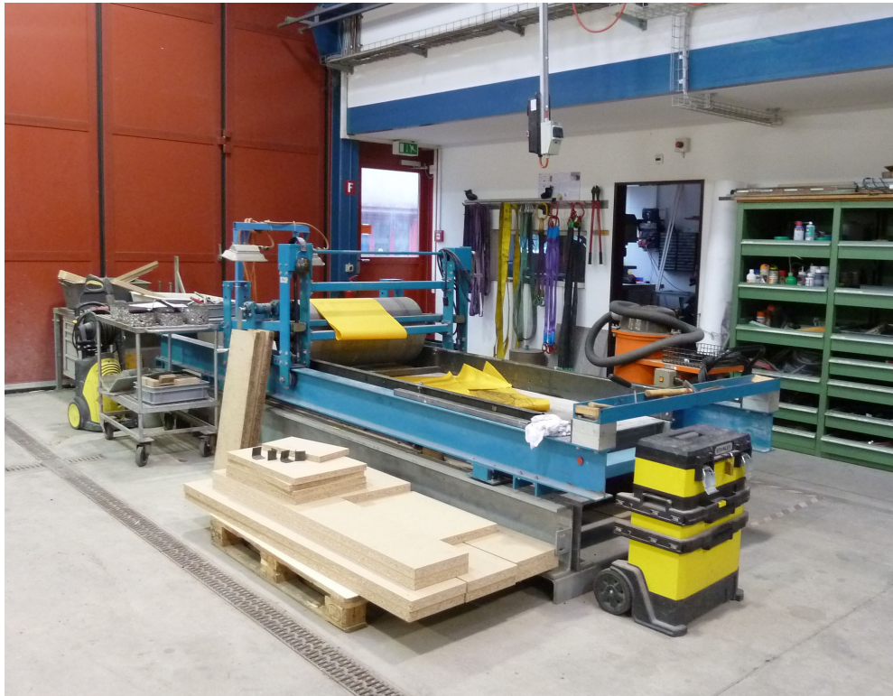
Abb. 15: Im Sektor D befindet sich gegenüber dem Nassbereich vor dem Eingang zur Werkstatt BP 105 und vor dem Hallentor in Richtung Dienstgebäude ein Walzenprüfstand.
