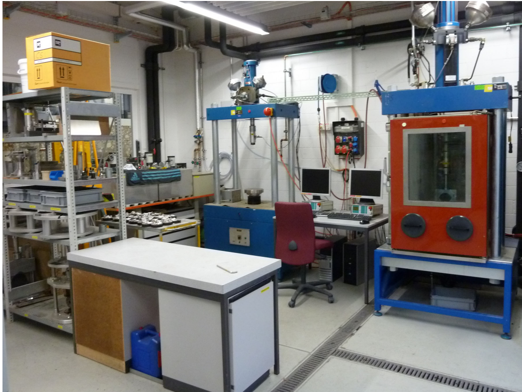
Abb. 19: Hydraulische Prüfstände im BP 103 (Sektor E). Es besteht eine eigene Hydrauliköl-Druckversorgung, die Pumpeneinheit dazu befindet sich auf dem Hallendach.
