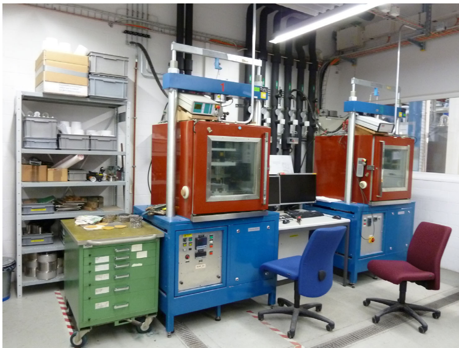
Abb. 18: Einer der Prüfstände in Sektor E (BP 103). Im Hintergrund erkennt man an der Wand die Versorgungsleitungen für 3 separate Kühlwasserkreisläufe. Der Raum ist klimatisiert.
