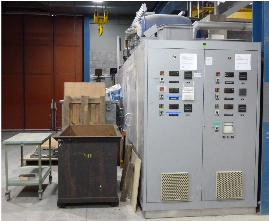
Abb. 11: Steuerschrank für Ofenzeile in Sektor C.
