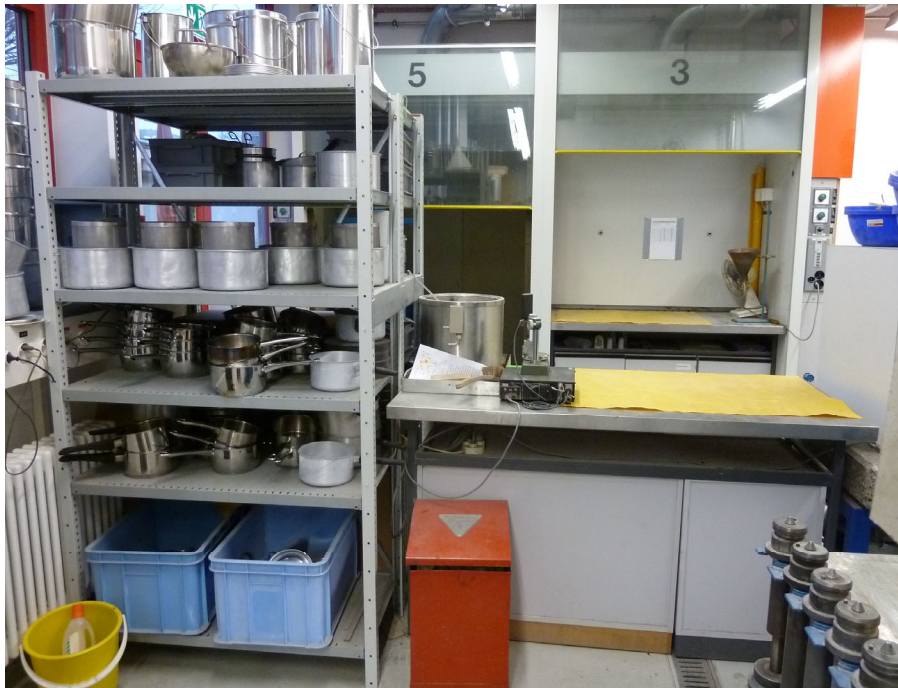
Abb. 23: Arbeitsflächen und Gerätschaften im Prüflabor Sektor F (BP 102). Aufgrund der Staubimmissionen sind zwei Abzüge vorhanden.
