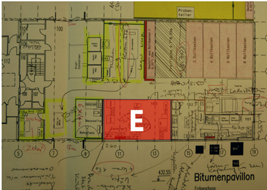
Abb. 17: Sektor E ist ein separat eingehauster Laborraum (BP 103), in dem sich die Prüfstände für Dynamische Materialprüfungen befinden.
