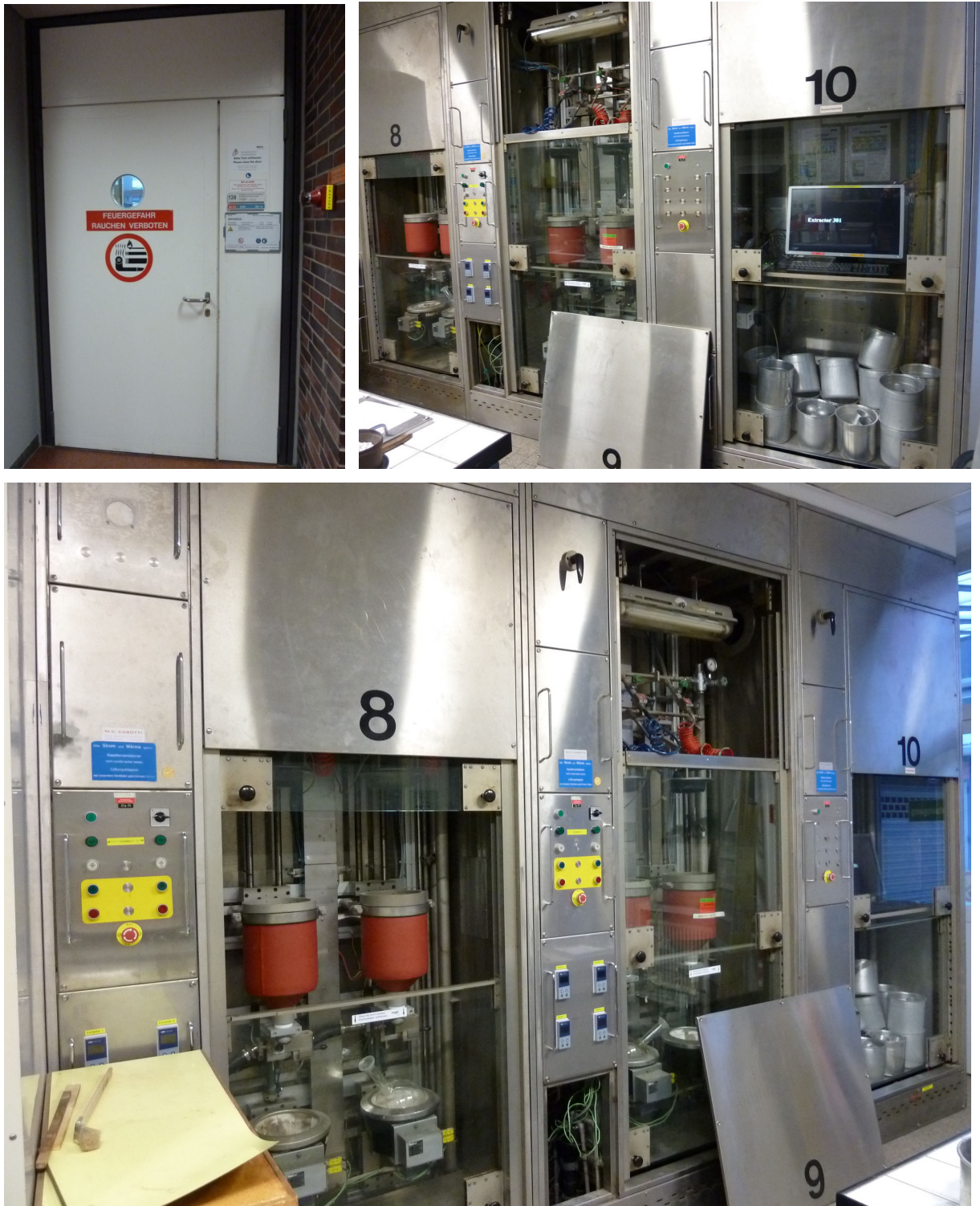
Abb. 30: Extraktionsanlage im LA 138. Die teilweise in Eigenkonstruktion erstellte Steuerelektronik ist am Ende ihrer Lebenszeit angekommen und kann mangels Empa-Ressourcen kaum mehr instand gehalten werden. (Anlage wird ersetzt)
