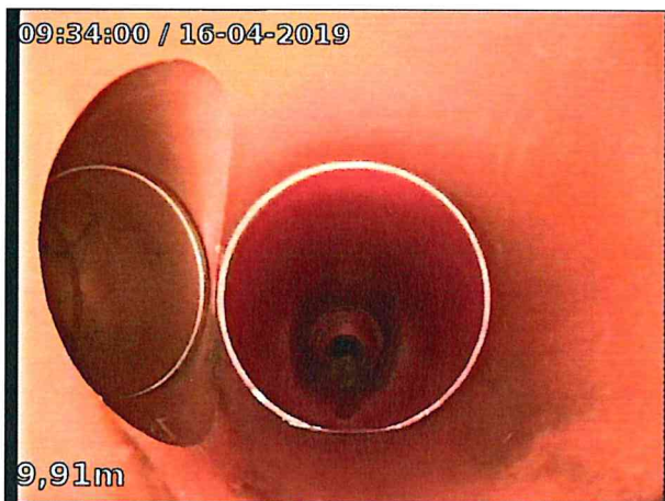
Photo: 6_8A, 00:01:05 10.1m, Embranchement à 09 h., en bon état
