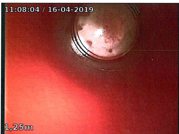
Photo: 14_4A, 00:00:42 1.3m, Fin du tuyau, obturé
