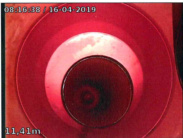
Photo: 1_9A, 00:02:01 11.41m, Diminution du diamètre
