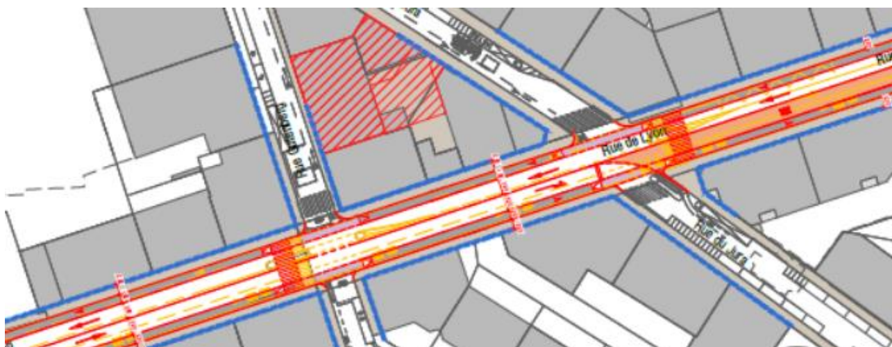
Figure 25 – Plan de voie modifié rue de Lyon : site propre bus après le rue du Jura (coupure du transit)
